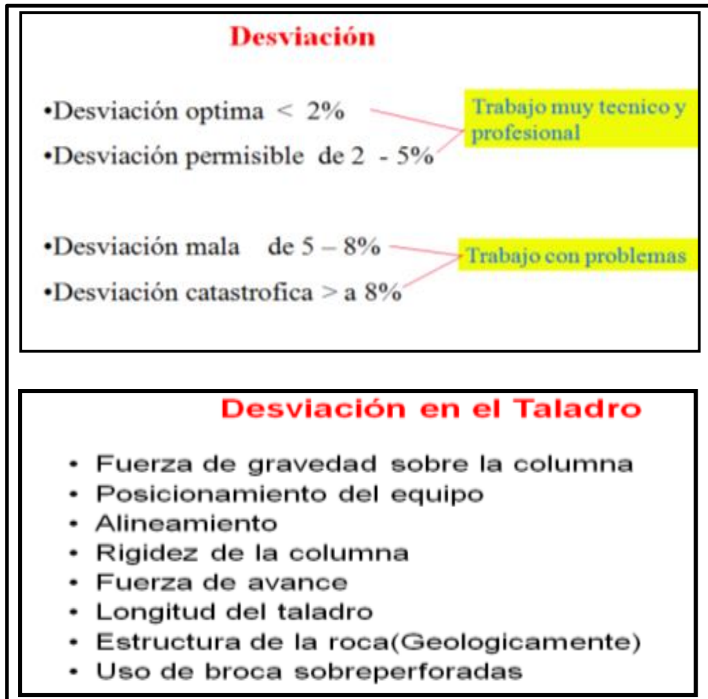
Figura 14. Resultado Geomecánico de la desviación del taladro perforado (Subterráneo Marcapunta Sur). Tomado de “El Brocal, JRC Ingeniería y Construcción”, por JRC Ingeniería y Construcción, 2014
