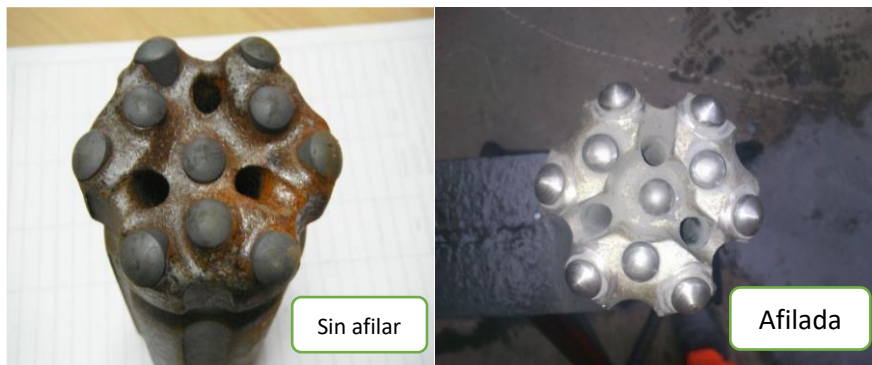
Figura N. 39. Comparación de brocas de 64 mm sin afilar y afilada
