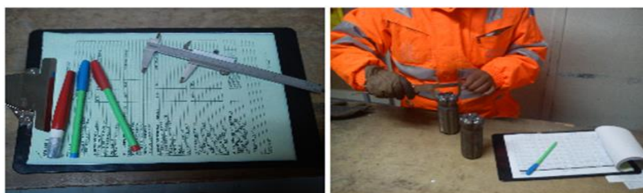
Figura N. 57. Control de las brocas en el diámetro y desgaste del inserto
