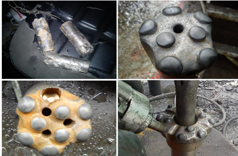
Figura N. 55. Mal control de los aceros de perforación por el operador del equipo.
