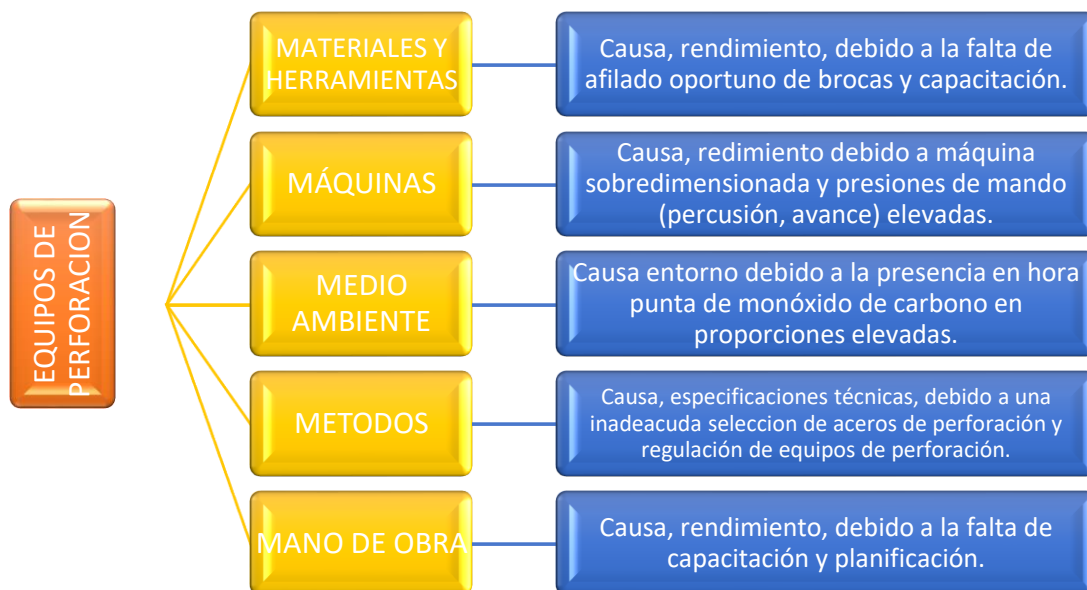
Figura N. 44. Equipos de perforación, causas generadoras de pérdidas
