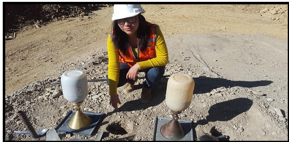
Figura 40: Determinación del volumen que ocupa la Arena Calibrada en el Agujero.
