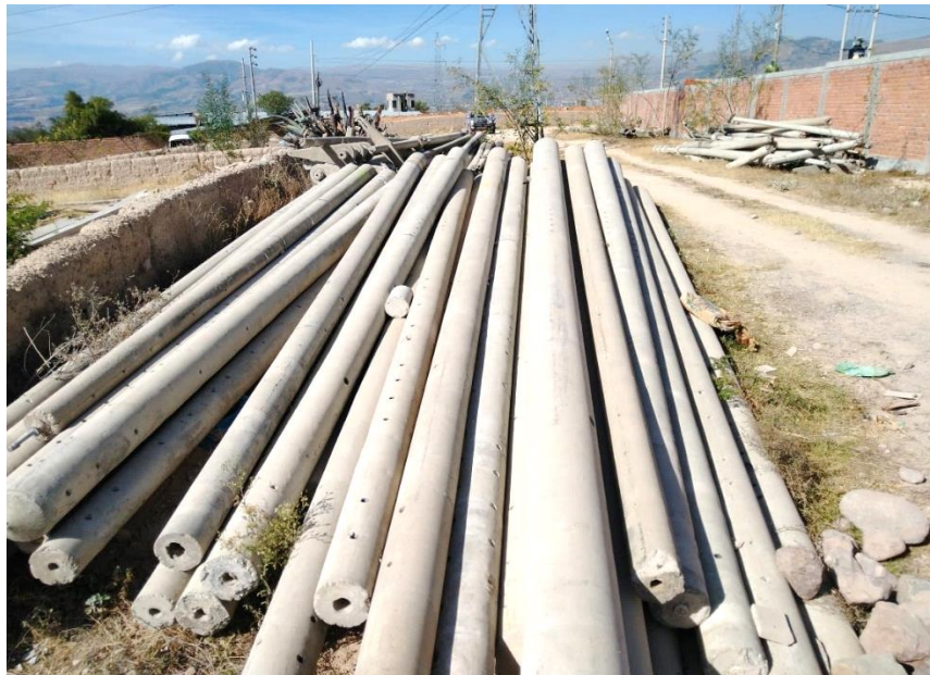
Figura 11: Almacén de postes de CAC media tensión.
