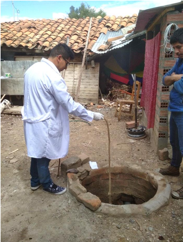
Fotografías 15 y 16. Toma de muestras de agua subterránea en Umuto.
