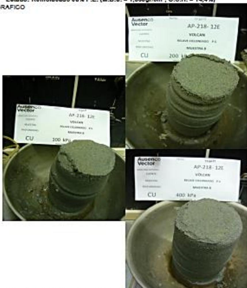
**Nota:** Los especímenes fueron remoldeado al 95% del Proctor Estándar con una Máxima Densidad Seca = 1,775gr/cm<sup>3</sup>, con el Óptimo Contenido Humedad = 14,4%
