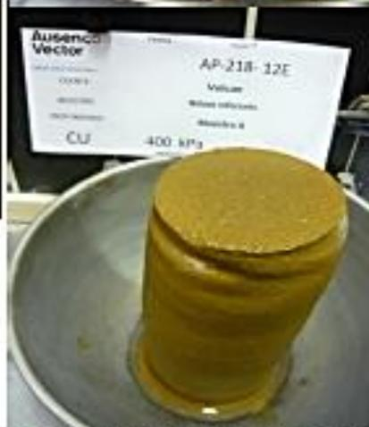
Nota: Los especímenes fueron remoldeado con una Densidad Seca = 1,799gr/cm<sup>3</sup>, Humedad = 11,2%
