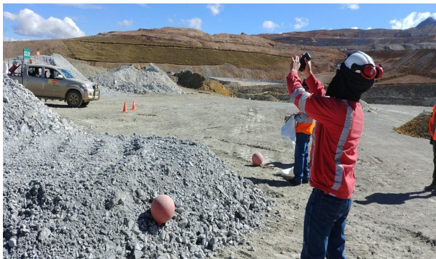
Figura 33. Toma de Fotografías para análisis granulométrico
