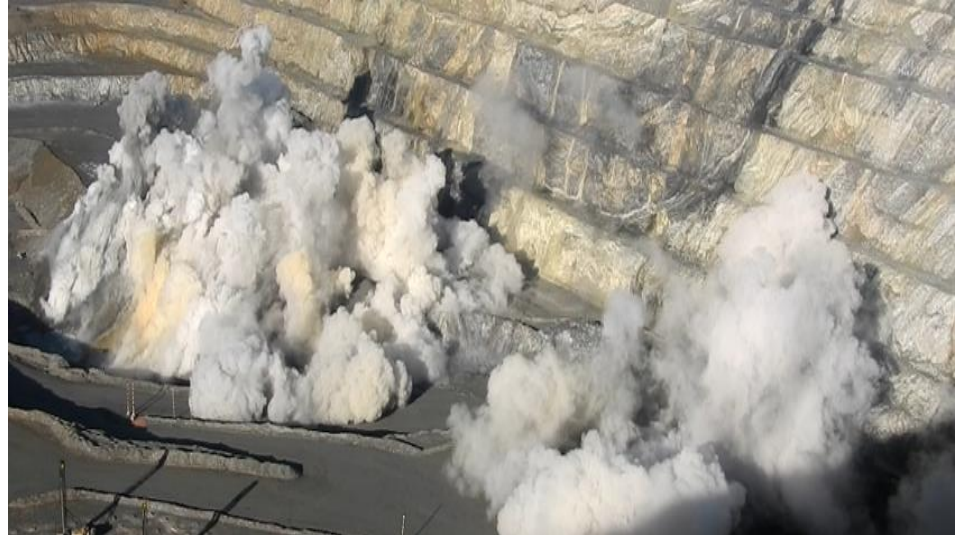
Figura 32. Postvoladura sin presencia de gases nitrosos
