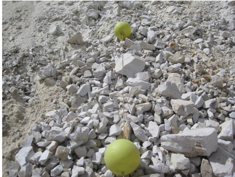
Figura 5. Esferas para análisis de fotos. Tomado de Split Desktop [software de computadora], por Split Engineering. Split Engineering LLC.
