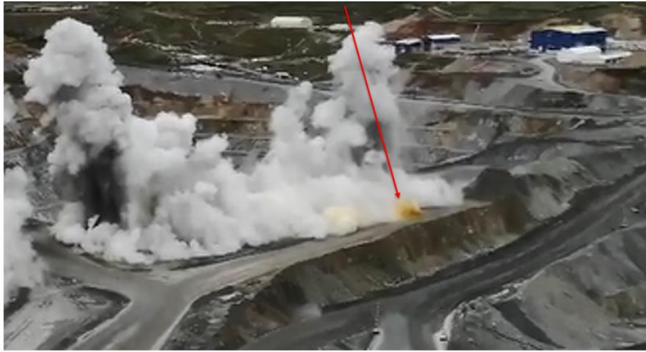
Figura 41. Voladura con leve generación de gases
