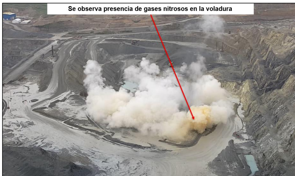
Figura 48. Voladura con mínima presencia de gases nitrosos
