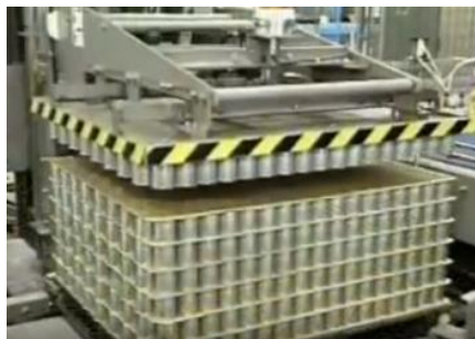
Ilustración 20. Proceso de Paletización Fuente: (WHALLON, 2019)
