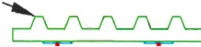
Ilustración 23. Greca Para Formación de Estrato Fuente: Elaboración Propia
