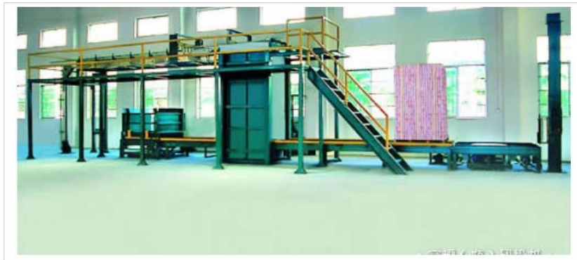
Ilustración 2. Paletizador de Latas Vacías Fuente: (JORDAN, 2006)
