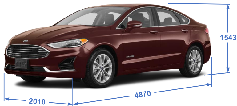
Figura 19. Dimensiones máximas de un vehículo tipo sedán, coupé o compacto.
