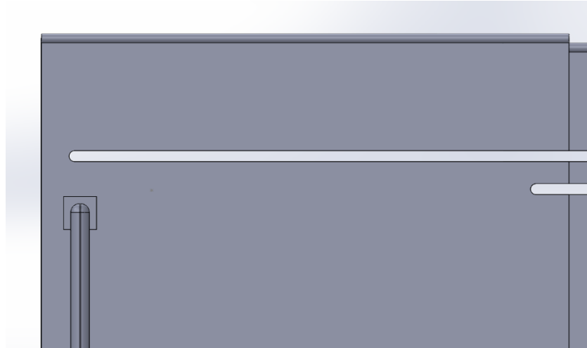
Figura 26. Aberturas longitudinales de las placas de la cubierta. (Fuente: Elaboración propia)
