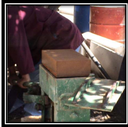
Figura 5: Elaboración de adobe estabilizado con cemento
