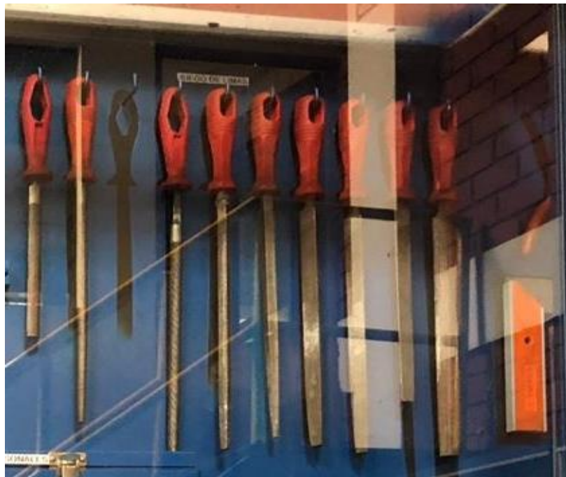
Ilustración 33.- Modelo de poka yoke aplicado al pañol de herramientas. Fuente: Inspección taller de Mantenimiento Transportes Libertad
