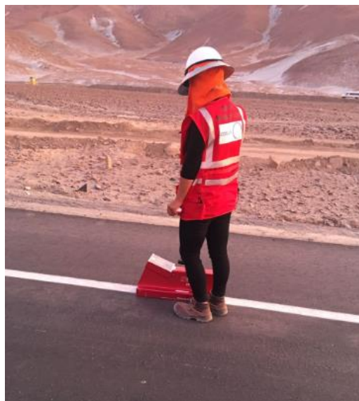
Figura N°50: Medición de retroreflectometría en marcas permanentes en señales horizontales
