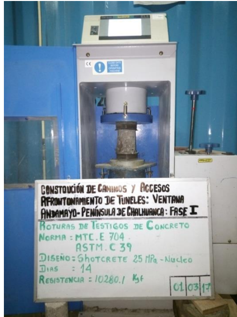
Figura N°65: Rotura a compresión de testigos de concreto
