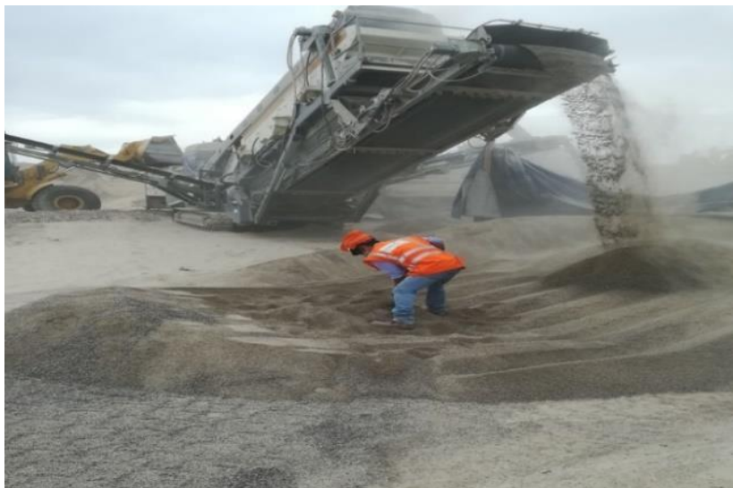
Figuras N° 35. Muestreo de los agregados para el asfalto
