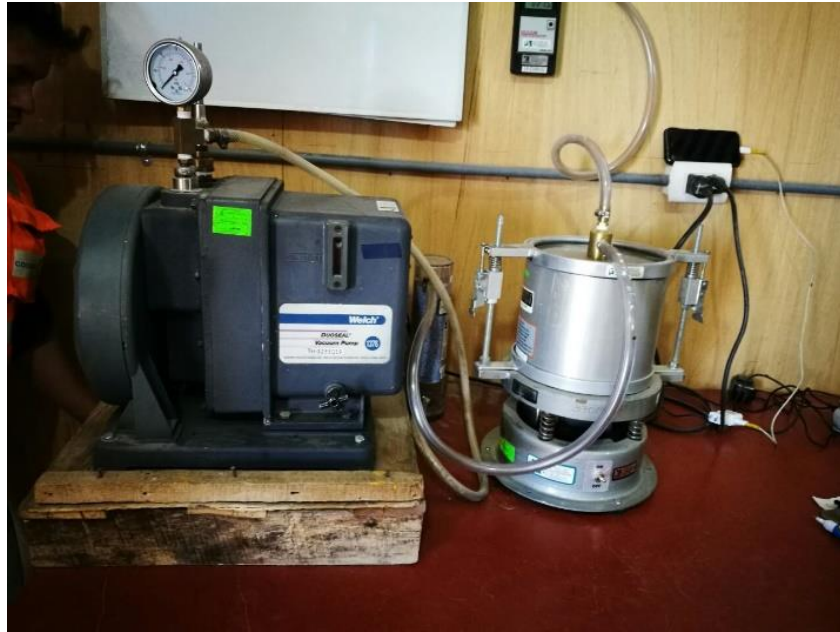
Figura N°29: Control de calidad de la mezcla asfáltica con el ensayo rice
