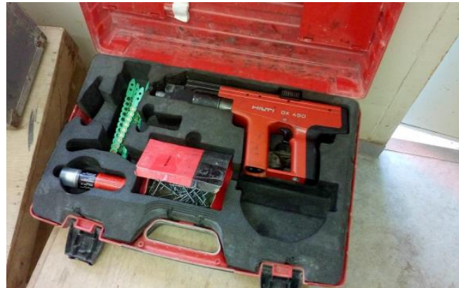
Figura N°78: Pistola Hilti – Método B, (Incado de Clavos)
