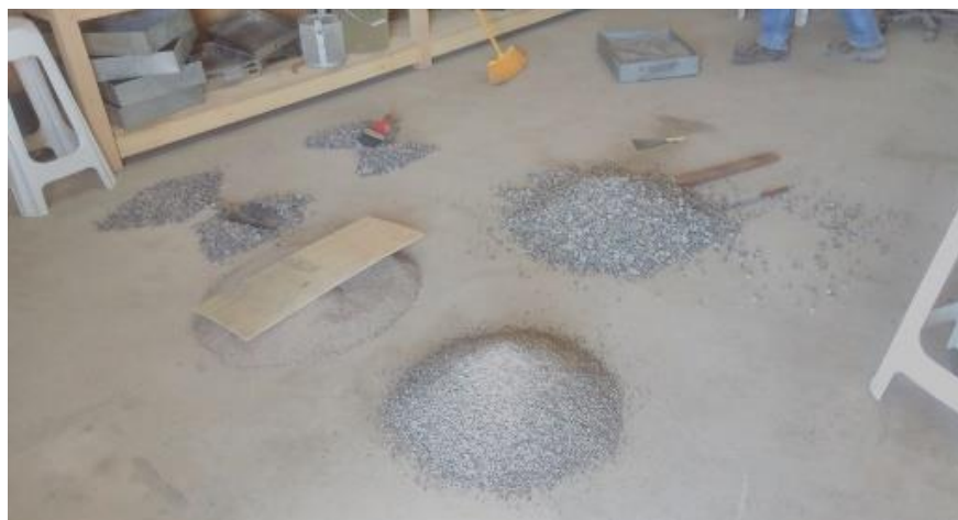
Figuras N° 36. Tamizado de los agregados para el asfalto por el Área de calidad
