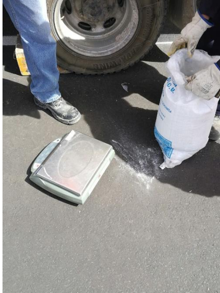
Figura N°46: Control de taza de microesferas para marcas permanentes en el pavimento
