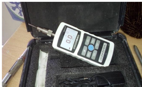
Figura N°77: Método A: Penetración de Aguja
