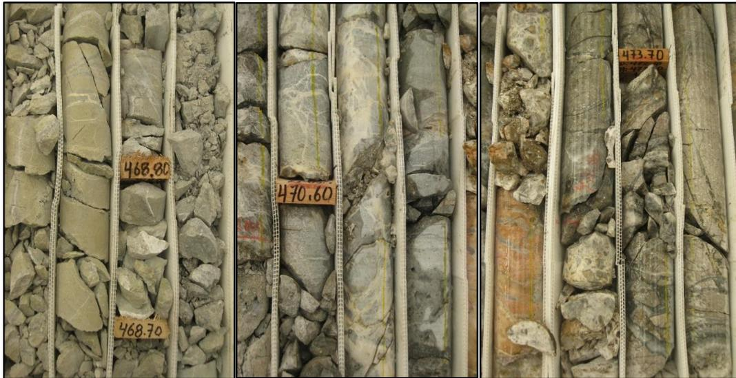
**FIGURA N° 12: ANIS 052517 (a) zona de alteración de sílice y Mn, 485 m, (b) Andesita violeta, ANIS 052517, 779 m**
