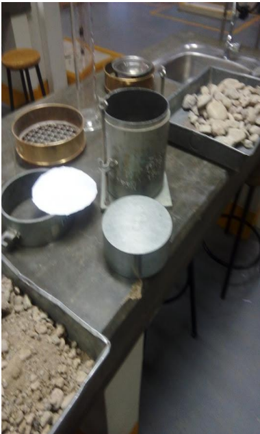
Materiales para realizar la compactación
