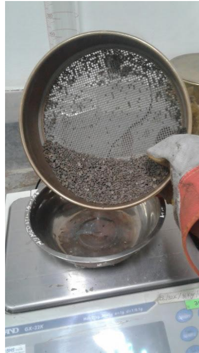
Fotografía N° 26 Material retenido en tamiz
