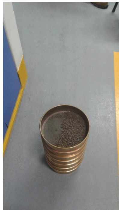
Fotografía N° 24 Tamizado de especímenes
