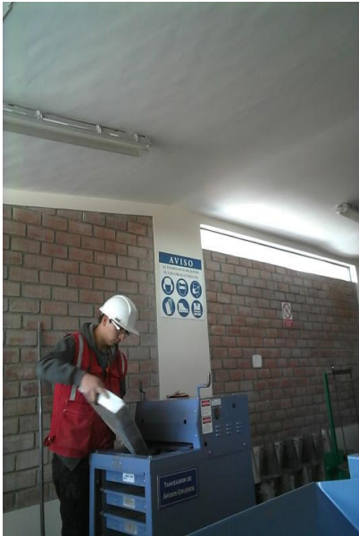
Vertido de la parte gruesa en la tamizadora mecánica
