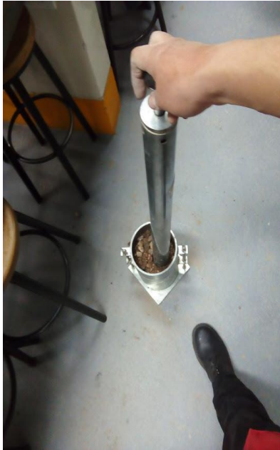
Compactación con pisón de 10 lb
