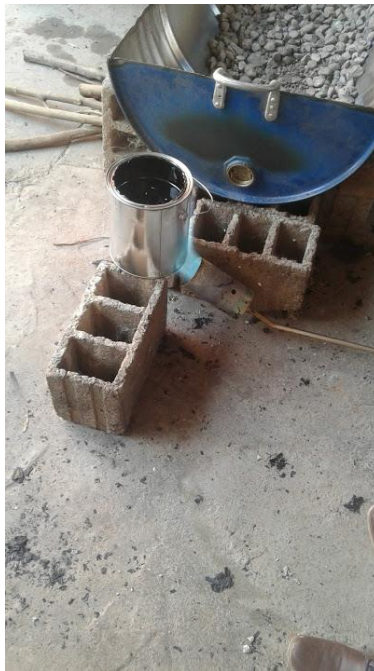
Fotografía N° 5 Compactado de parche en molde
