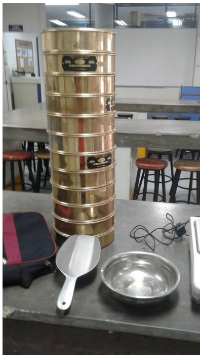
Fotografía N° 23 Juego de tamices para realizar en ensayo
