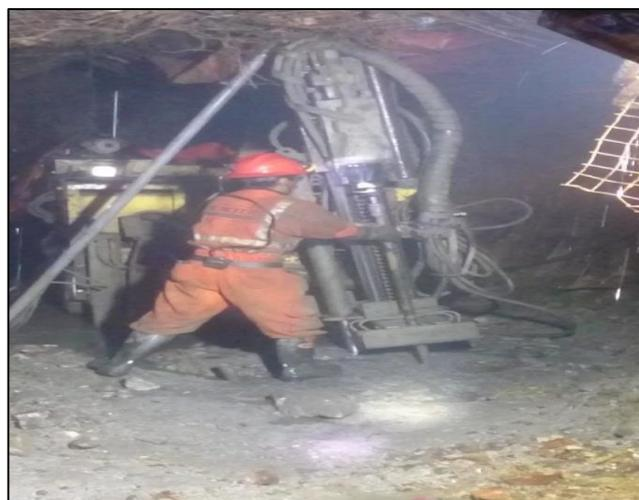
**Figura 17.** Recuperación de la columna de barras de perforación.
