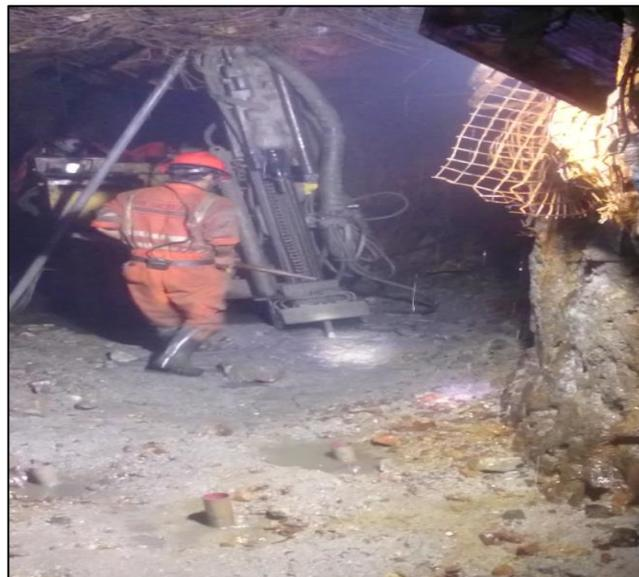
**Figura 28.** Correcto posicionamiento y acople de las barras de perforación en el equipo.
