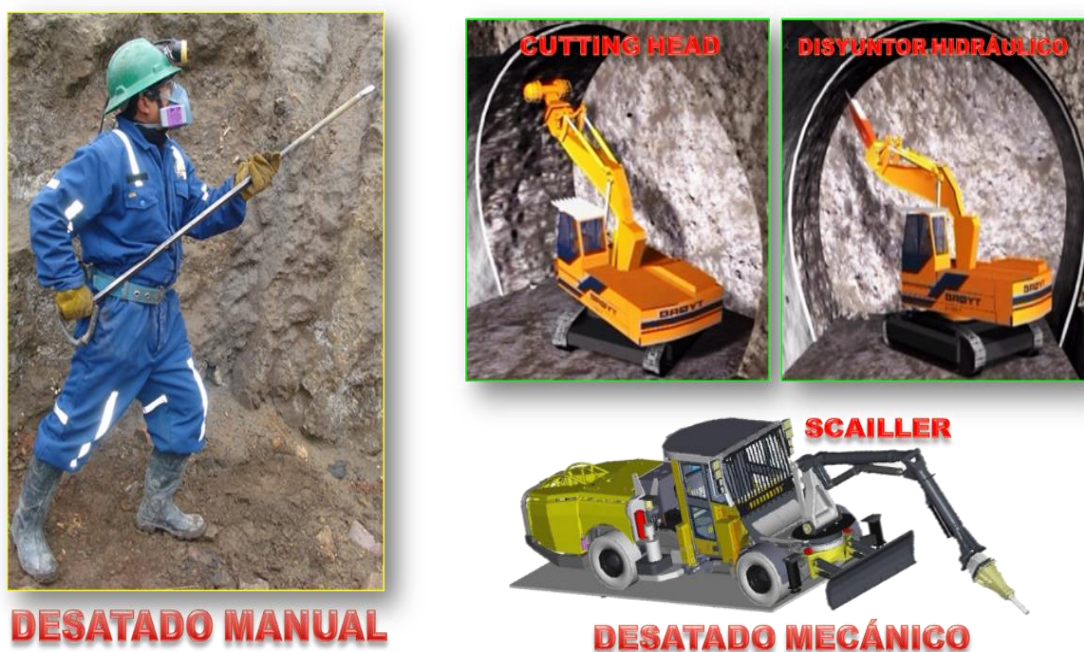
Figura N°10 Desatado manual y mecánico de Rocas
