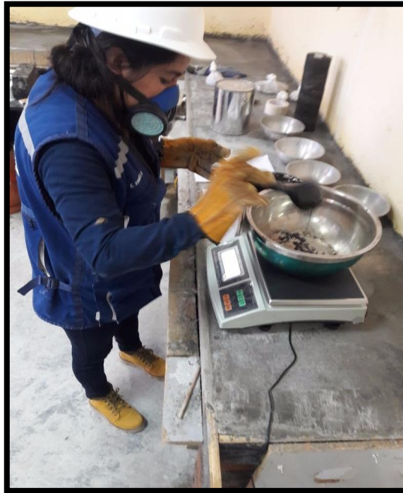
Figura 14. Echado de asfalto al agregado.
