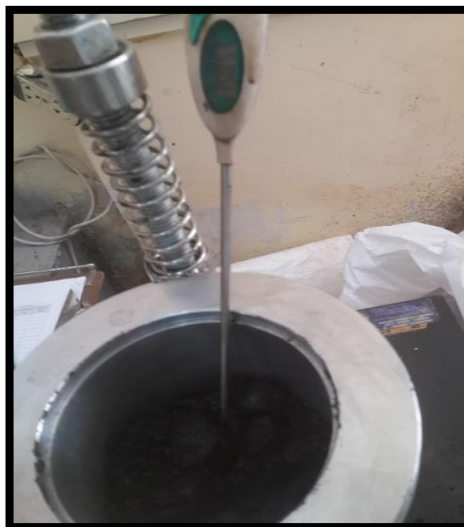
Figura 21. Compactación a 160°C
