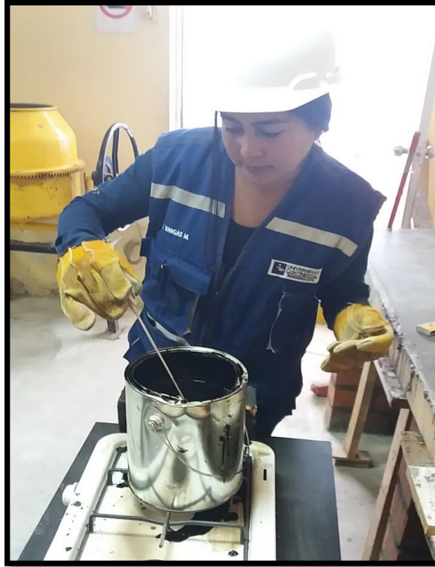
Fotografía 05: Calentamiento del asfalto a 160°.
