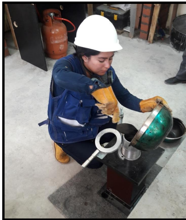
Fotografía 08: Vaciado de la mezcla a la briqueta ubicada en el pedestal de compactación.
