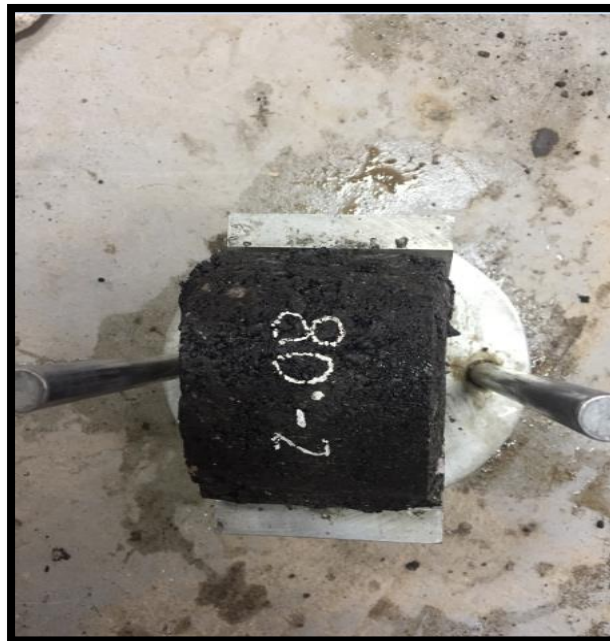
Fotografía 16: Especimen N°2 a temperatura de compactación de 80°, del cual se observa que incrementa el volumen de vacíos de aire.
