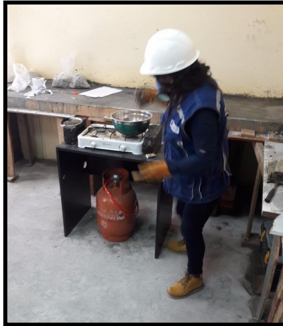
Figura 16. Mezcla de agregado y asfalto.
