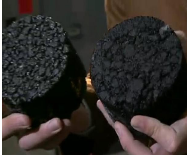
Figura 6. Briquetas de Marshall. Fuente: (Ciaffaroni, 2011)
