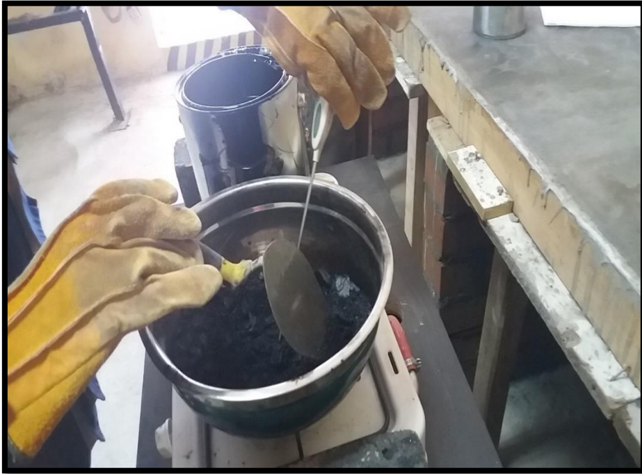
Fotografía 07: Combinación de agregado y asfalto a 160°.
