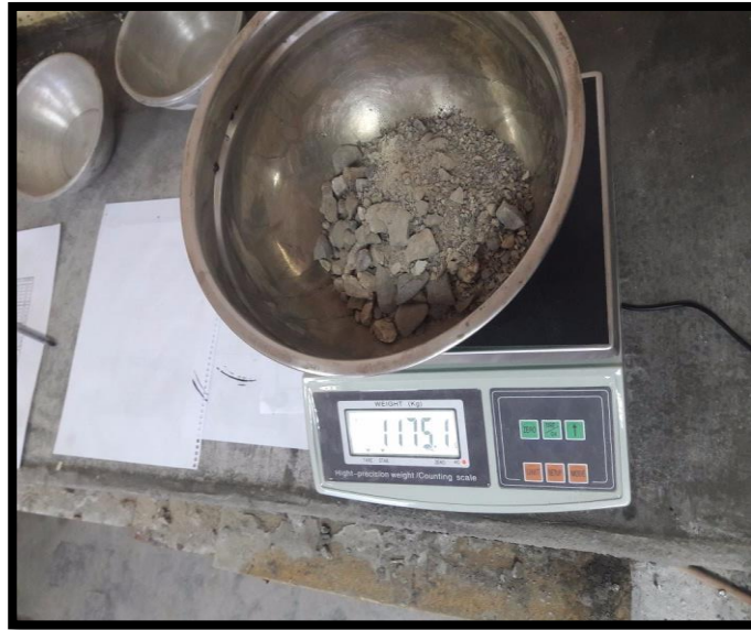
Figura 13. Peso para 6% de asfalto
