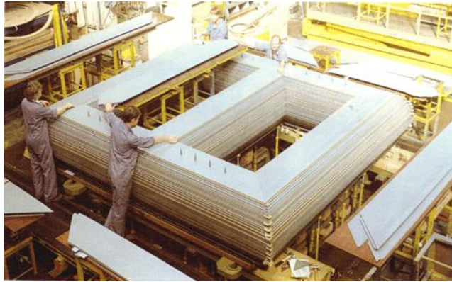
Figura 25. Unión mediante técnica Step-Lap.
