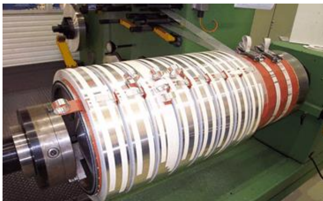
Figura 26. Bobinado de un arrollamiento
