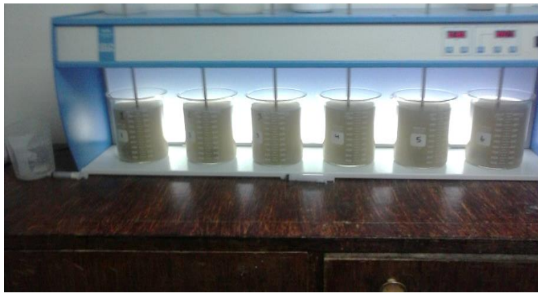
Figura 15: Prueba de Jarras con el agua de mina cruda.
