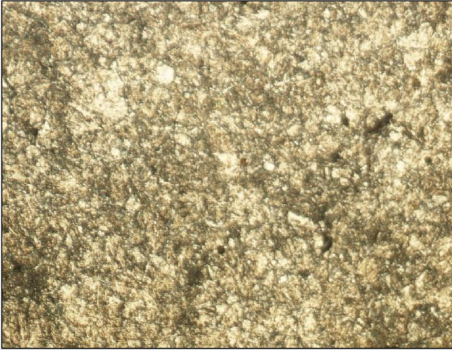
Figura 47. Microestructura del acero, temple en salmuera a 500x (Núcleo).
