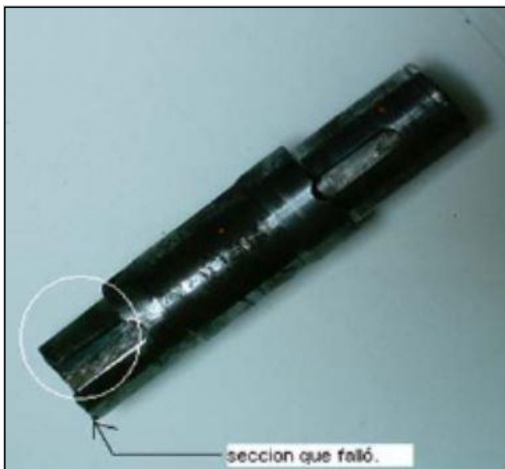
Figura 6. Eje de acero SAE 1045 de un reductor con efectos de grieta.
