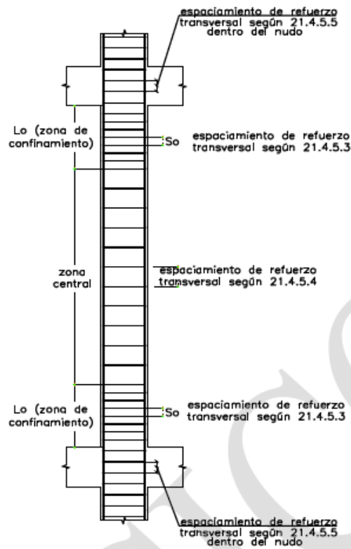
Figura 67: Distribución de estribos por zona para columnas Fuente: Disposiciones especiales para el diseño sísmico (E060)
