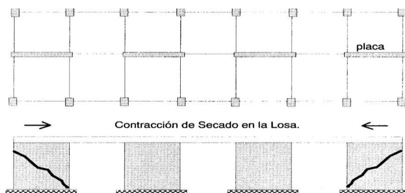
Figura 16: Efecto de fallas por contracción del concreto Fuente: Análisis de Edificios (San Bartolomé, 1998)
