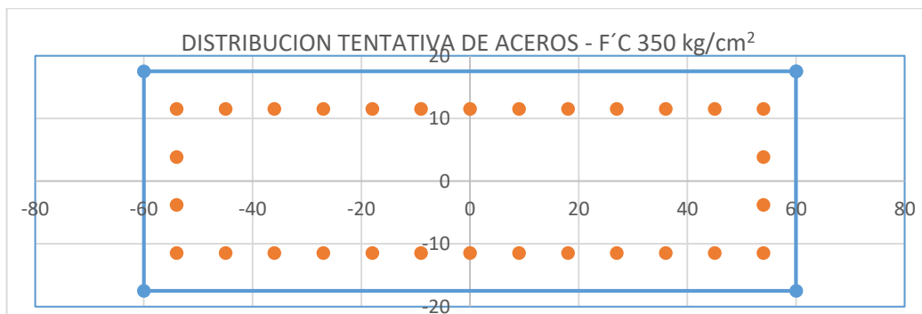
Figura 73: Distribución tentativa de acero con f'c=350\text{kg/cm}^2
