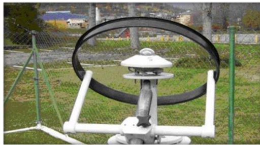
Figura 5. Piranómetro con banda de sombra Fuente: Sosa Naranjo, Cristina., 2006.
