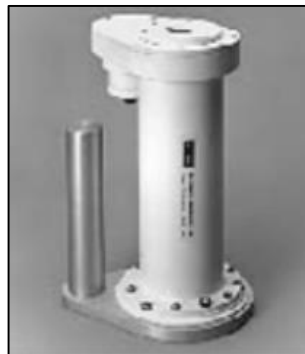
Figura 4. Pirheliómetro absoluto de cavidad Fuente: Sosa Naranjo, Cristina., 2006.
