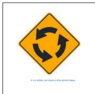
**Figura 37.** P-15 Señal de intersección rotatoria
