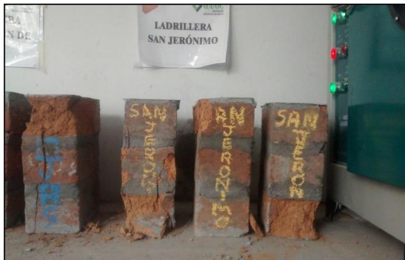
Fotografía 37. Fallas por esfuerzo a la compresión – ladrillo artesanal
