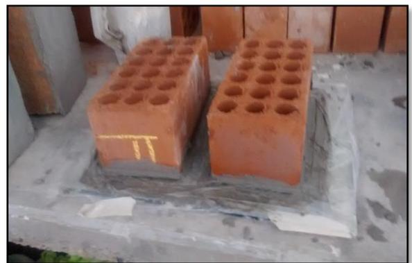
**Fotografía 29. Capping de las unidades de albañilería.**
