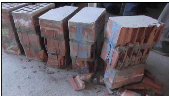
**Fotografía 53. Falla de unidades de albañilería industrial.**
