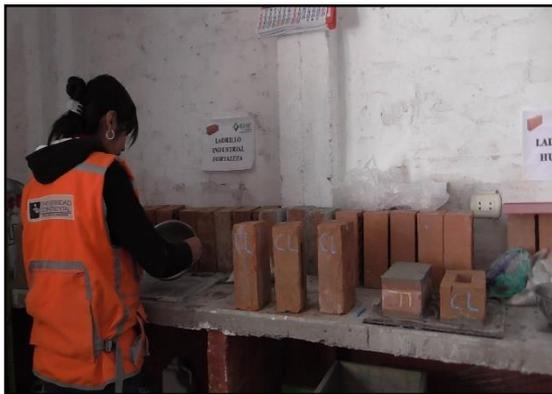
**Fotografía 28. Capping de las unidades de albañilería.**
