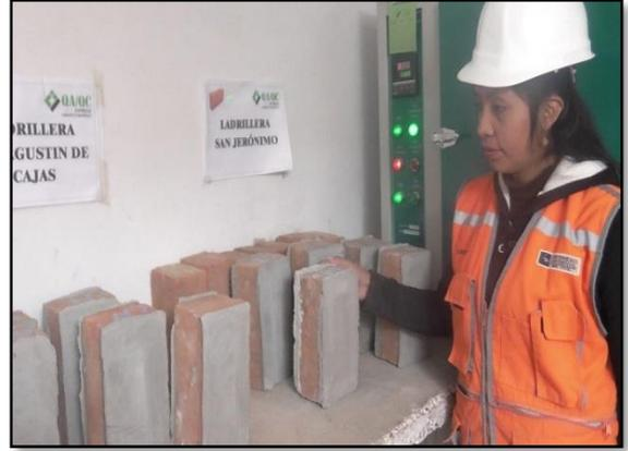
**Fotografía 31. Capping de las unidades de albañilería artesanales.**
