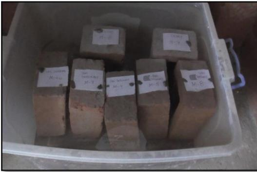
**Fotografía 24. Ensayo de absorción de las unidades artesanales.**
