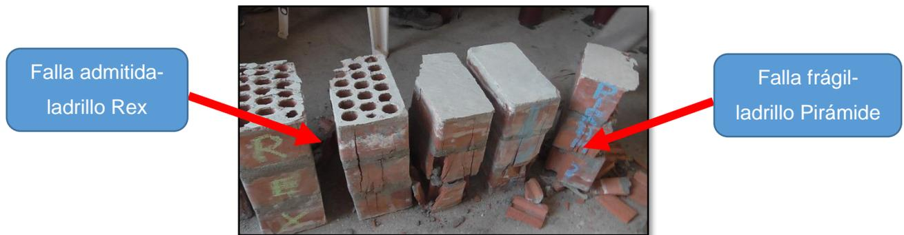
**Fotografía 56.**Fallas de las pilas de unidades de albañilería industrial.
