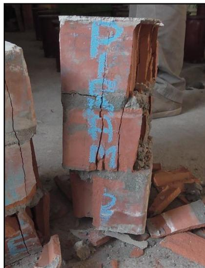
**Fotografía 57.**Falla frágil de las pilas de unidades de albañilería industrial .
