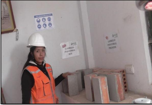
**Fotografía 30. Capping de las unidades de albañilería industriales.**
