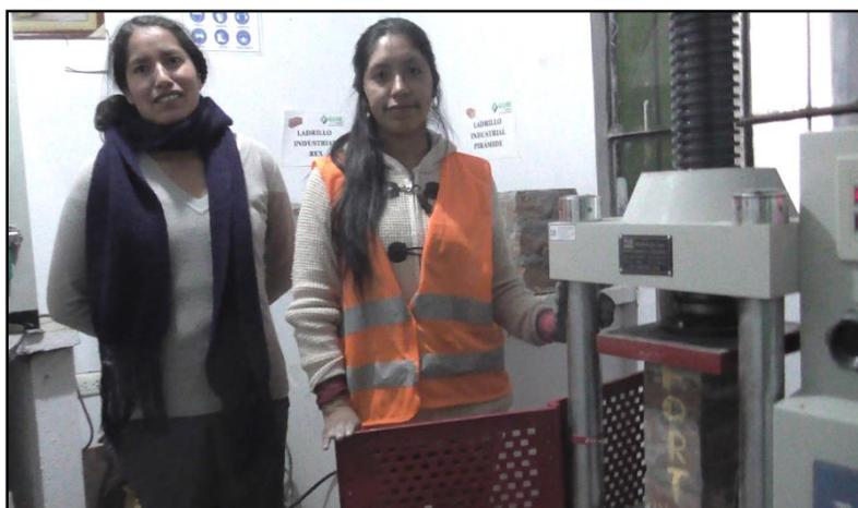
**Fotografía 40. Ensayo a la compresión de pilas de albañilería industrial**
