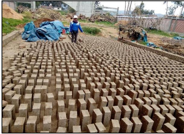
**Fotografía 16. Secado de ladrillos (arrumado).**
