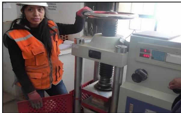
Fotografía 46. Ensayo resistencia a la compresión de ladrillo industrial.
