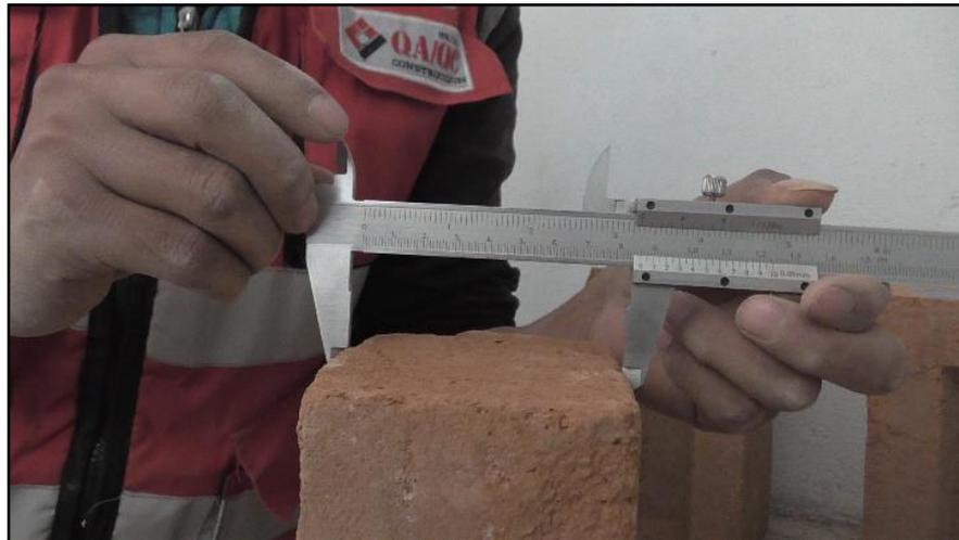
**Fotografía 23. Ensayo de Variación dimensional**
