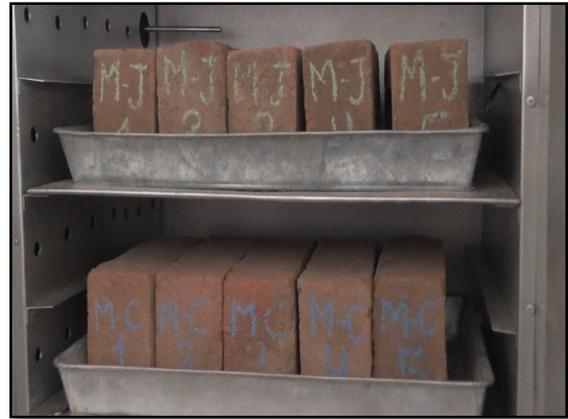
Fotografía 19. Secado de unidades de albañilería artesanales
