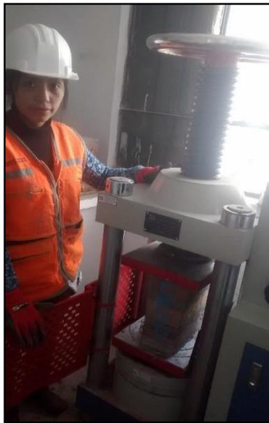
**Fotografía 51. Pilas de unidades de albañilería artesanal sometida a compresión.**
