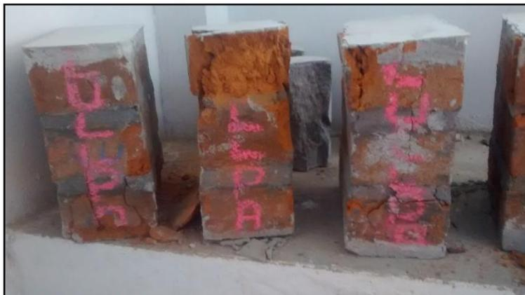
Fotografía 55.Falla por trituración - unidades de albañilería artesanales
