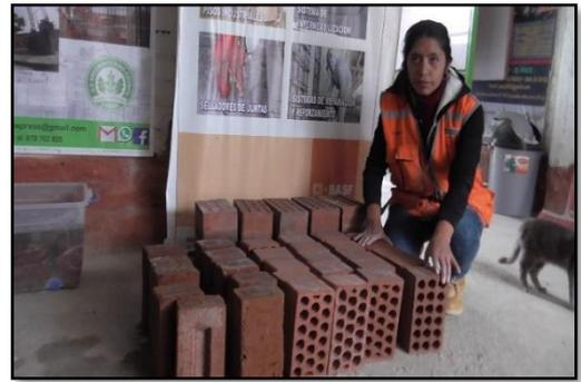
Fotografía 48. Unidades de albañilería industrial sometida a la absorción
