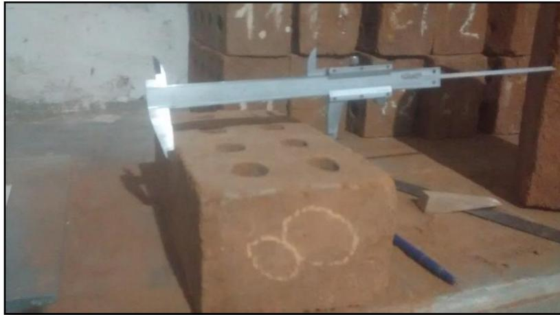
**Fotografía 64. Unidad de albañilería artesanal propuesta – Variación dimensional**
