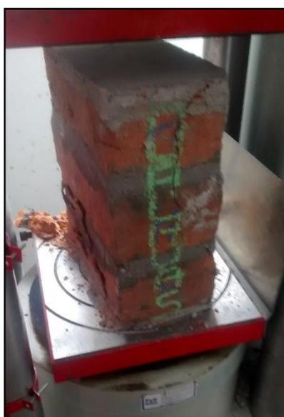
**Fotografía 54. Falla por trituración- pila de unidades artesanales**
