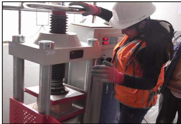
Fotografía 45. Ensayo resistencia a la compresión de ladrillo artesanal.
