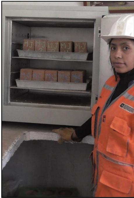
**Fotografía 21. Secado de unidades de albañilería artesanal.**
