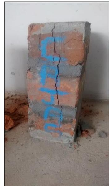
**Fotografía 52. Pilas de unidades de albañilería artesanal sometida a compresión**
