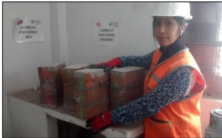
Fotografía 36. Fallas por esfuerzo a la compresión – ladrillo artesanal
