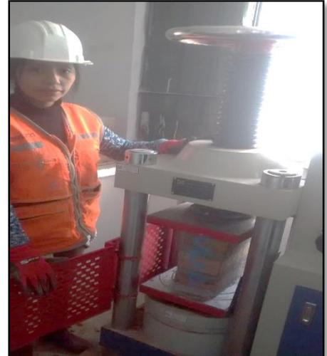
Fotografía 35. Ensayo a la compresión de pilas artesnales.
