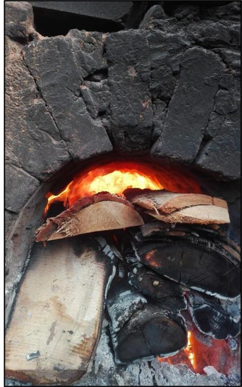
**Fotografía 53. Cocción de unidades de albañilería propuesta.**
