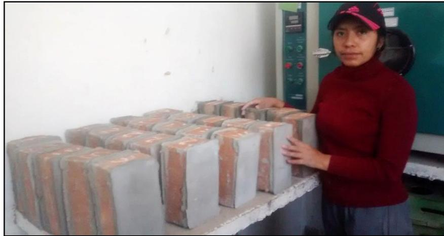
**Fotografía 67. Unidades de albañilería artesanal propuesta sometida a capping**
