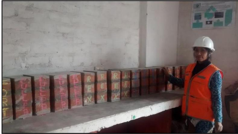
**Fotografía 38. Pilas de ladrillo industrial**
