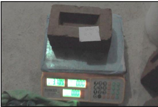
**Fotografía 26. Peso de la unidad de albañilería artesanal- ensayo de absorción.**
