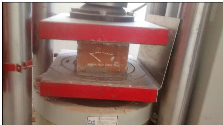
**Fotografía 68. Unidades de albañilería artesanal propuesta sometida a compresión**
