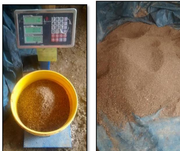
**Fotografía 62. Dosificación de materiales (arcilla y aserrín)**
