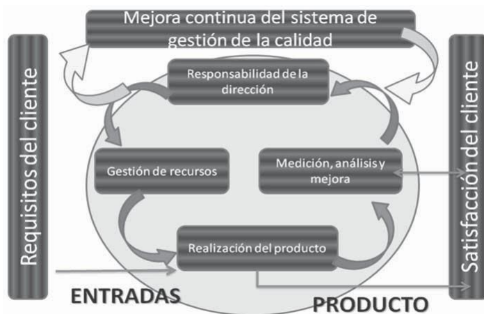
Figura 8. Modelo de un sistema de gestión de calidad basado en procesos. Tomando de NTC ISO 9001,2008
