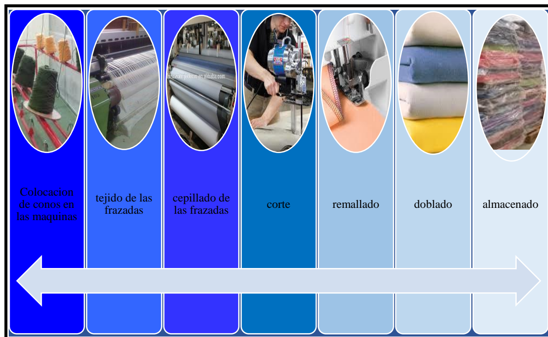
Figura 10. Flujograma del proceso productivo de las frazadas de 1 plaza.
