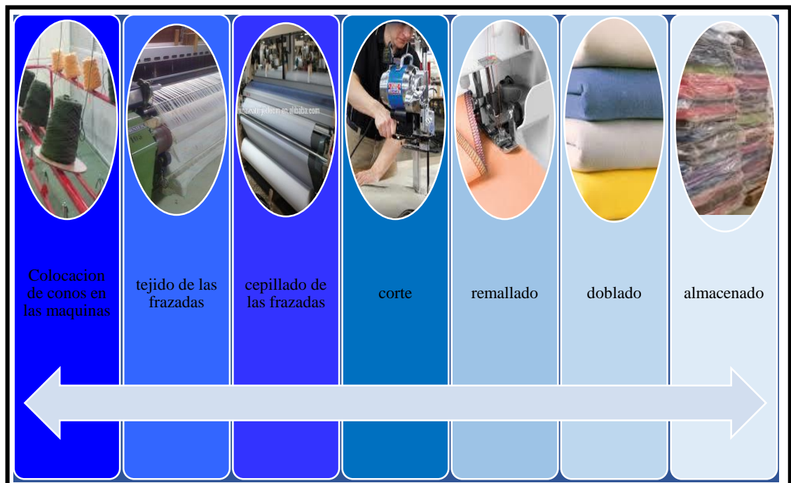
Figura 12. Flujograma del proceso productivo de las frazadas de 2 plazas.
