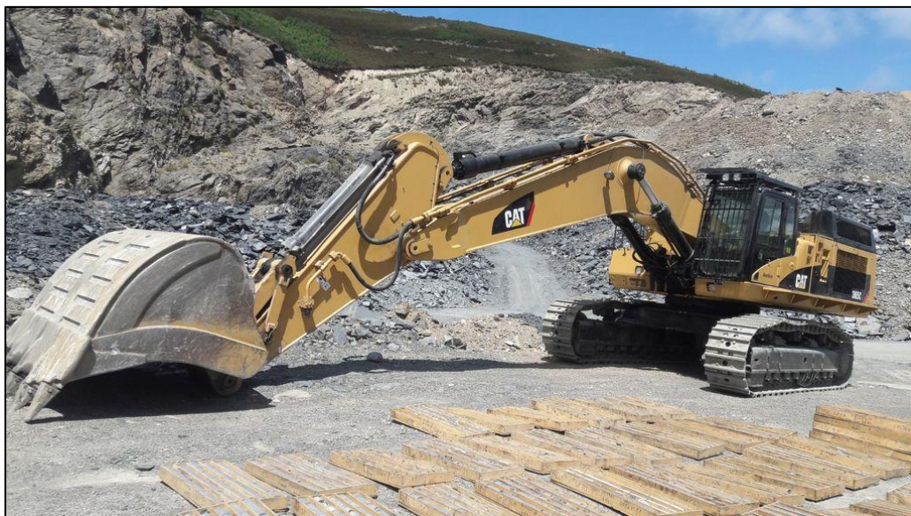
Figura 5. Excavadora CAT 365CL
