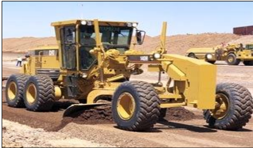
Figura 6. Motoniveladora CAT 140H
