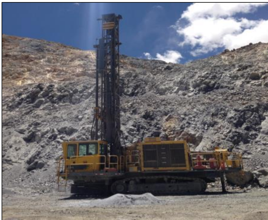
Figura 1. Perforadora rotativa Atlas Copco DML
