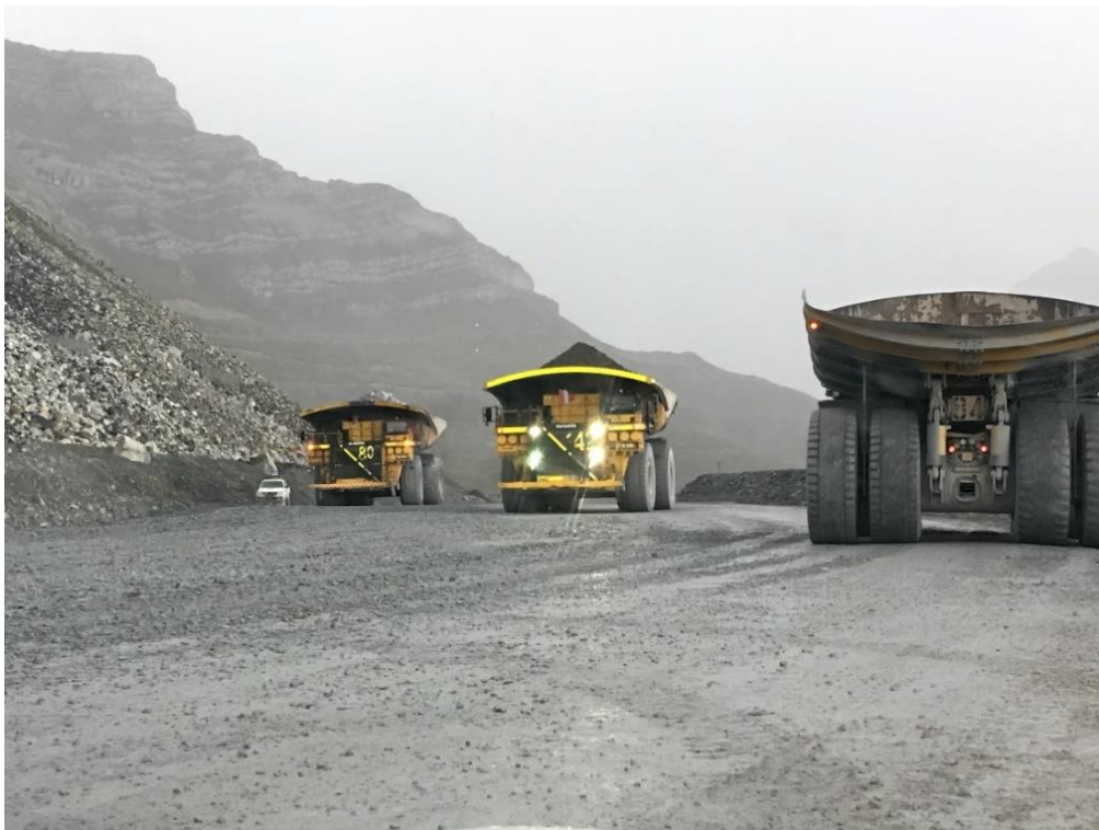
Figura 3: Reducción del ancho operativo de la vía de tránsito
