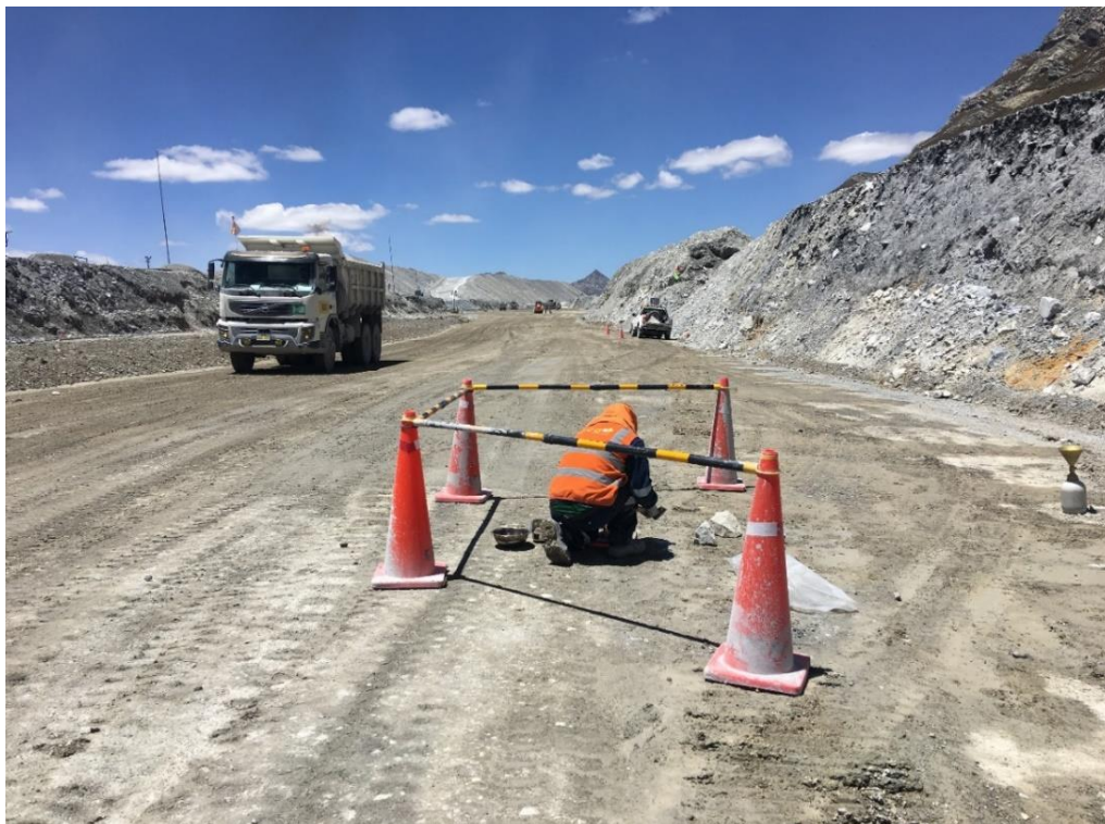
Figura 20: Ensayo de densidad de campo, verificar compactación óptima
