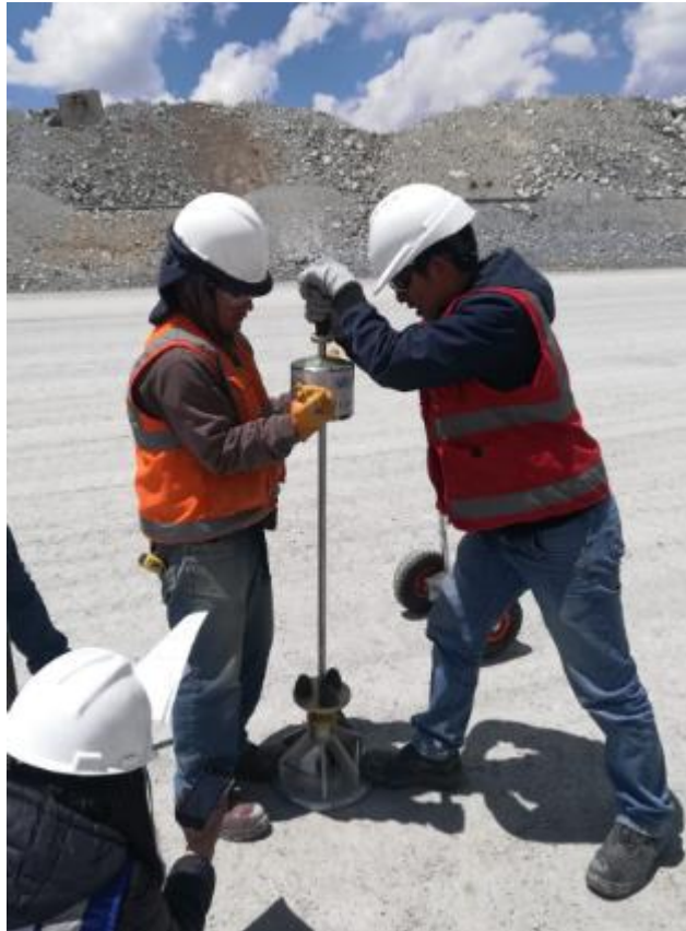
Figura 108. Evaluación estructural con LWD al proyecto de vía minera.
