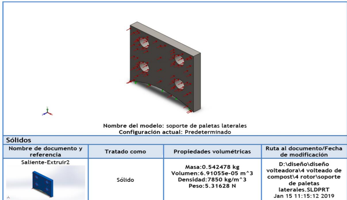
Figura 84. Modelamiento de soporte diagonal en Solidworks
