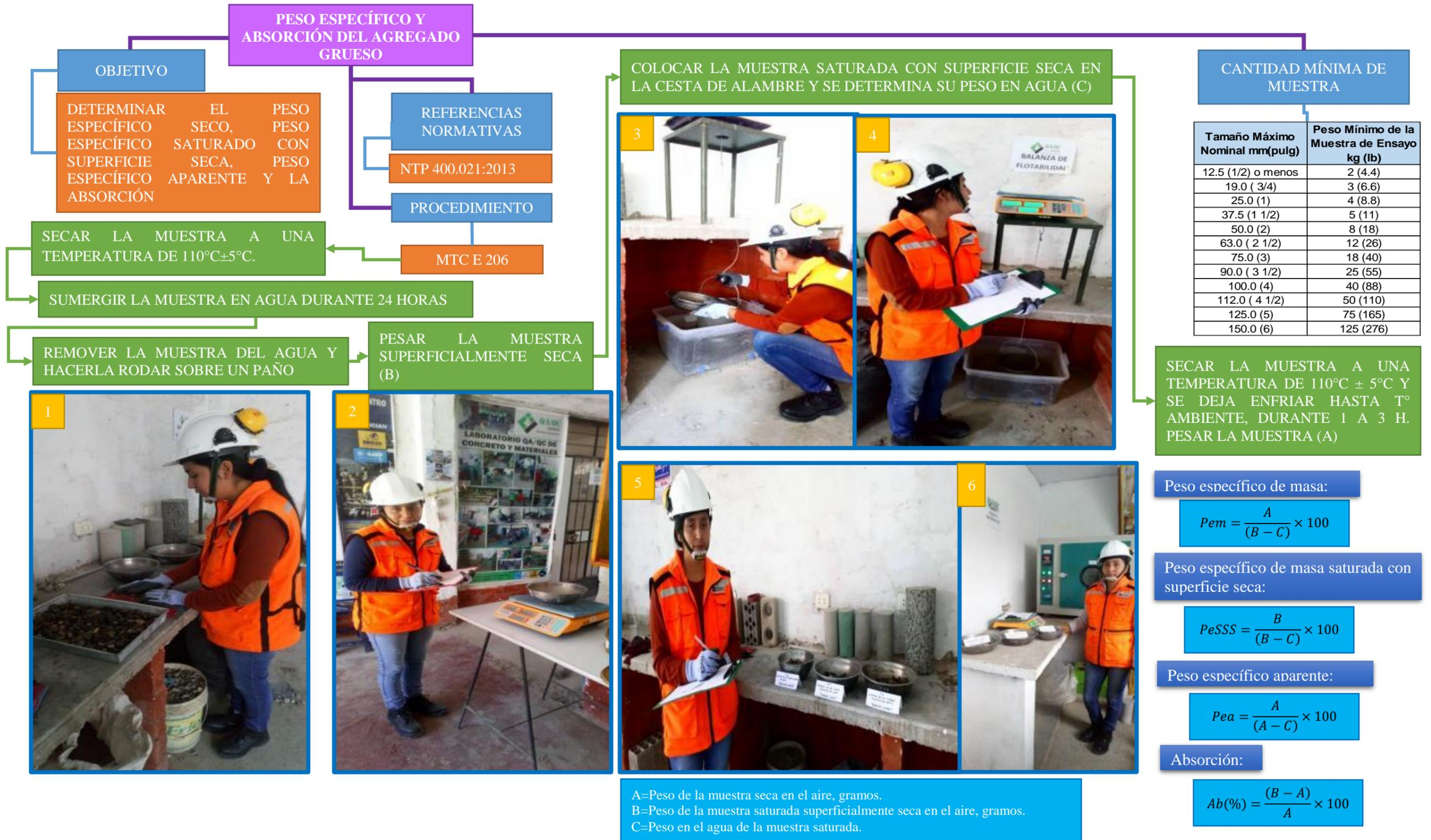
Diagrama 22. Peso Específico y Absorción del Agregado Grueso. Fuente: Elaboración propia (2018).
