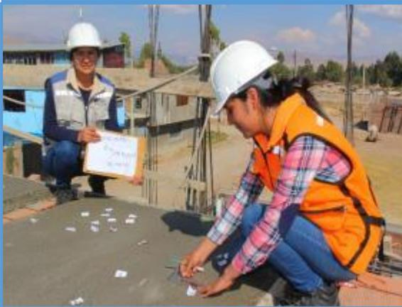
**Collage Fotográfico 03:** Control de fisuración por contracción plástica en losa aligerada para una combinación de mezcla  $f'c = 210 \text{ kg/cm}^2$  SIN FIBRA. 2017.
