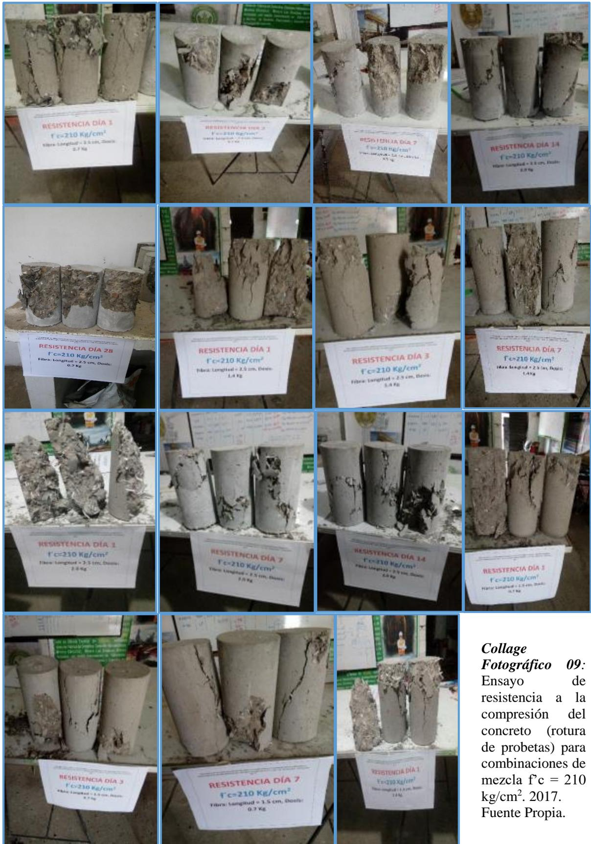
**Collage Fotográfico 09:** Ensayo de resistencia a la compresión del concreto (rotura de probetas) para combinaciones de mezcla  $f'_c = 210 \text{ kg/cm}^2$ . 2017. Fuente Propia.
