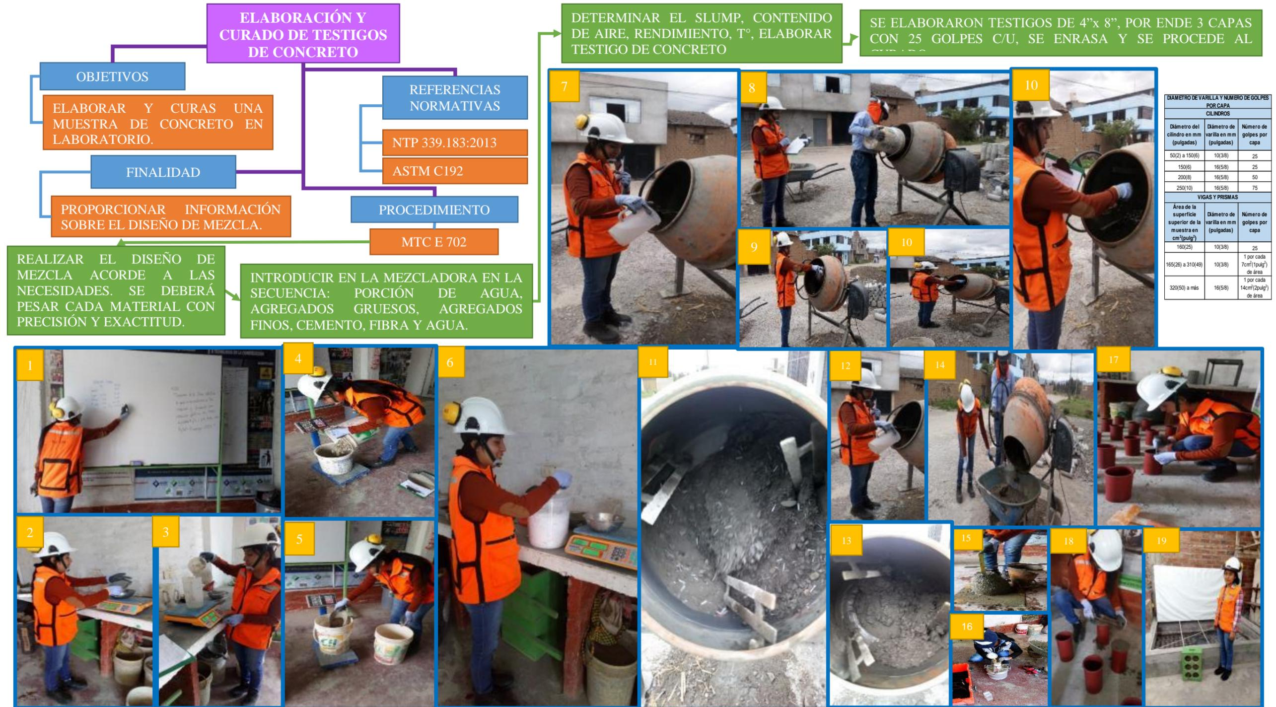
**Diagrama 3. 1.** Elaboración y curado de testigos de concreto en Laboratorio.
