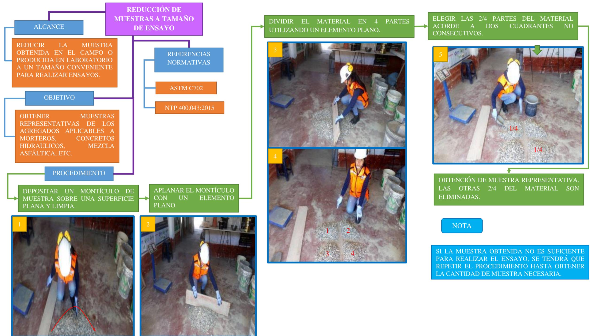
**Diagrama 14.** Reducción de muestras a tamaño de ensayo de los agregados
