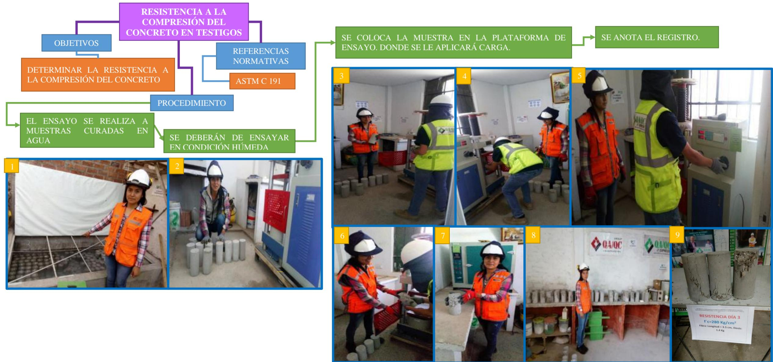
**Diagrama 29.** Resistencia a la compresión del Concreto en Testigos.
