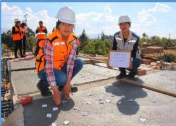
**Collage Fotográfico 07:** Control de fisuración por contracción plástica en losa aligerada para una combinación de mezcla  $f'c = 280 \text{ kg/cm}^2$  SIN FIBRA. 2017.
