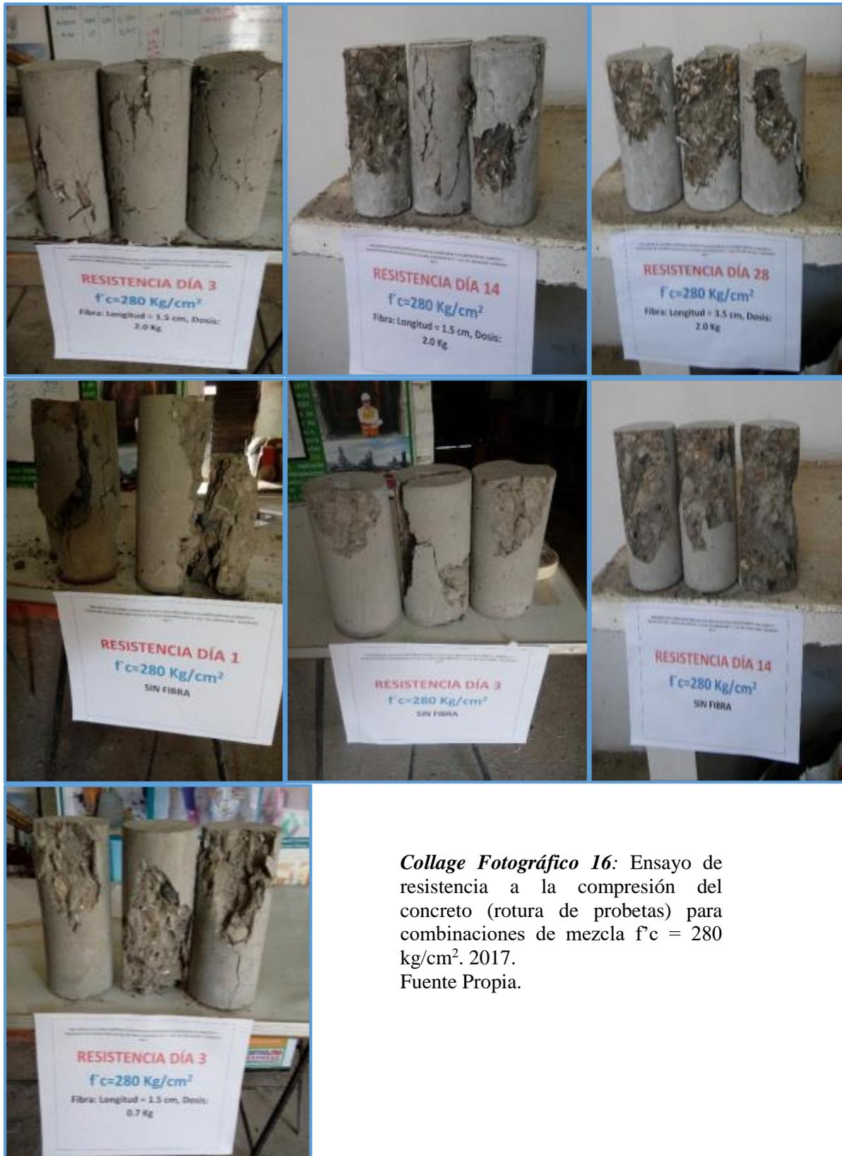
**Collage Fotográfico 16:** Ensayo de resistencia a la compresión del concreto (rotura de probetas) para combinaciones de mezcla  $f'c = 280 \text{ kg/cm}^2$ . 2017. Fuente Propia.
