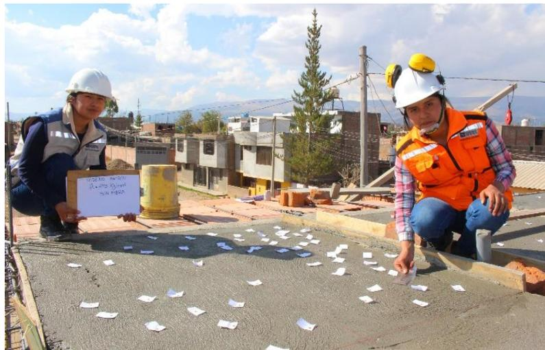
**Figura 17.** Control de fisuras en losa aligerada con  $f'c = 245 \text{ kg/cm}^2$  sin el uso de fibras
