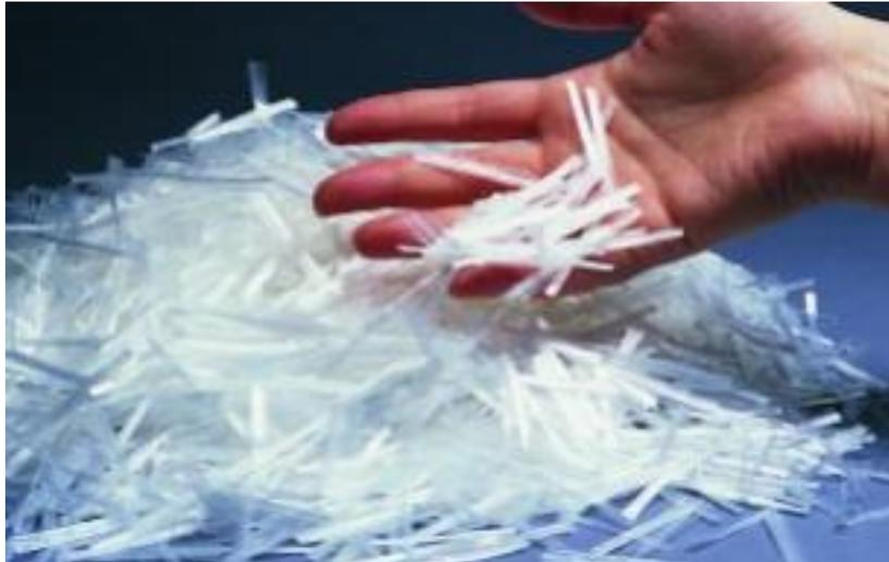
*Figura 8.* Fibra sintética de polipropileno.
