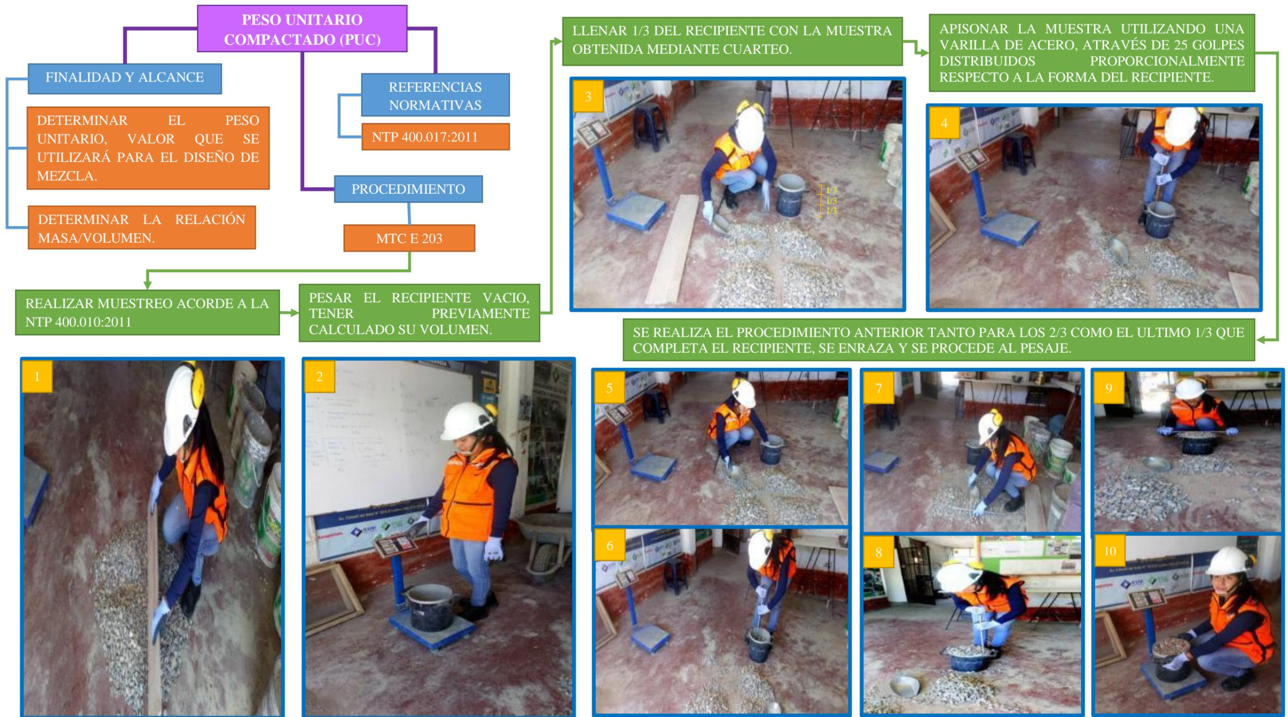
$$P.U.C = \frac{(\text{Peso del Agregado Grueso Compactado} + \text{Peso del Recipiente}) - \text{Peso del Recipiente}}{\text{Volumen del Recipiente}}$$
