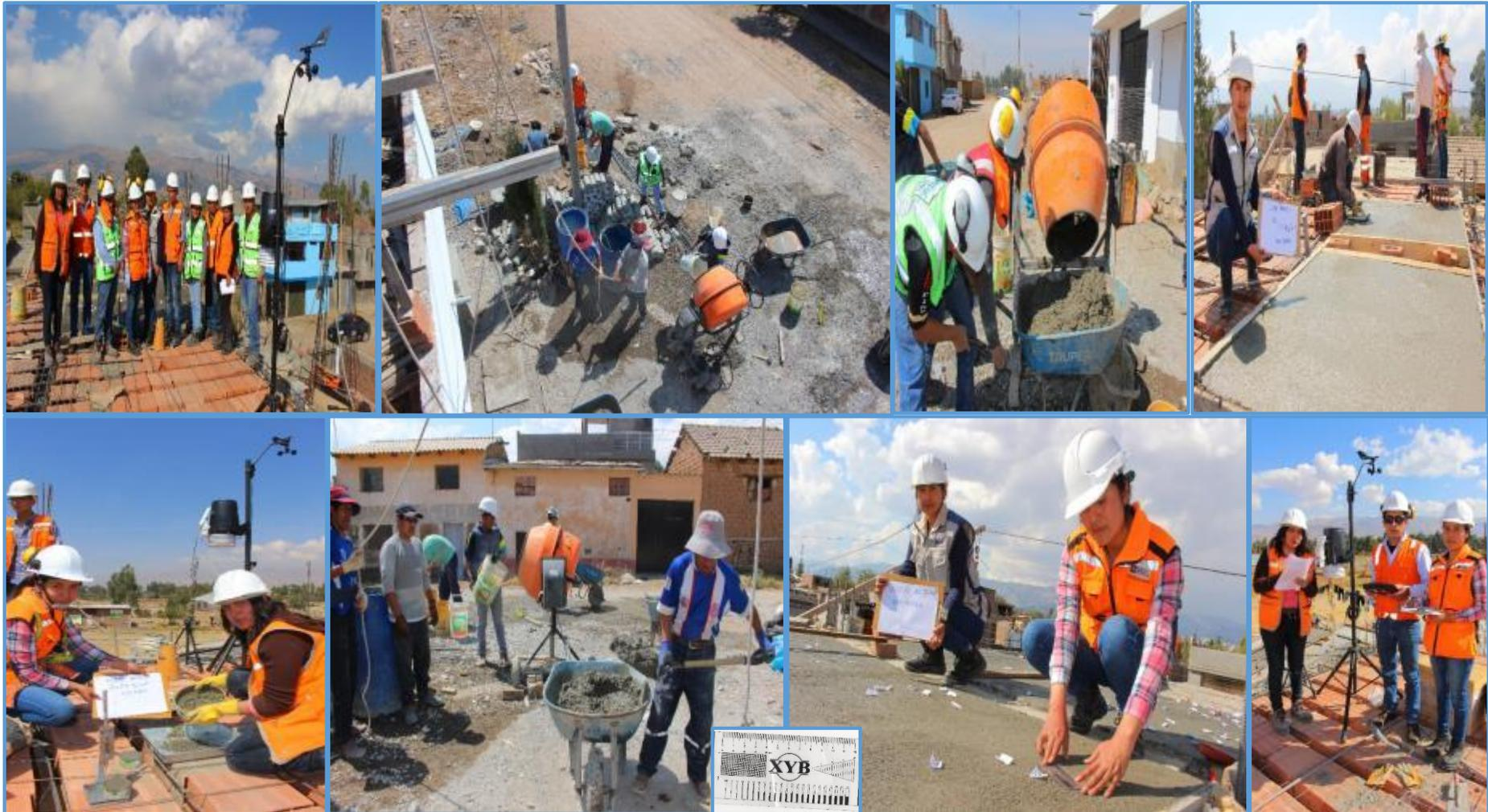
**Collage Fotográfico 02:** Se inicia con el proceso de mezclado del concreto con las combinaciones de mezcla elegidas, se realizan los ensayos en estado fresco (tiempo de fragua, temperatura del concreto, Slump, etc) y se procede con el control de fisuración por contracción plástica en losas aligeradas utilizando tarjetero – regla de control de fisuras. 2017. Fuente Propia.
