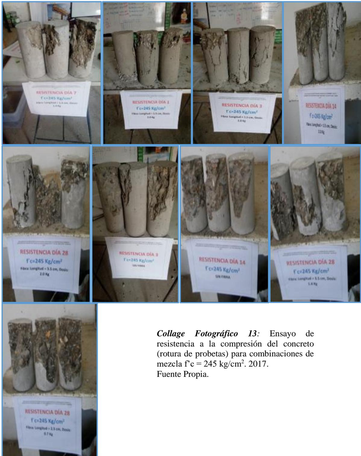
**Collage Fotográfico 13:** Ensayo de resistencia a la compresión del concreto (rotura de probetas) para combinaciones de mezcla  $f'c = 245 \text{ kg/cm}^2$ . 2017.
