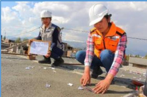
**Collage Fotográfico 04:** Control de fisuración por contracción plástica en losa aligerada para una combinación de mezcla  $f'c = 210 \text{ kg/cm}^2$  L2-D1. 2017. Fuente Propia.
