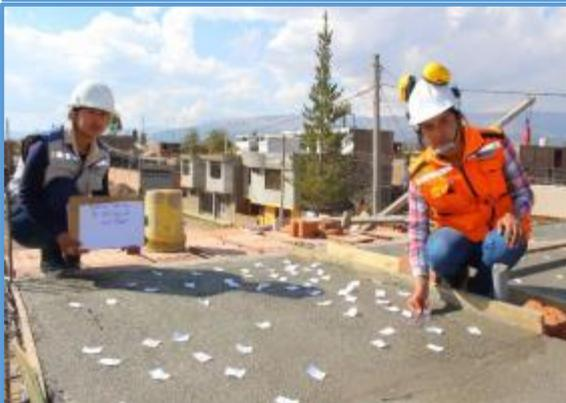
**Collage Fotográfico 05:** Control de fisuración por contracción plástica en losa aligerada para una combinación de mezcla  $f'c = 245 \text{ kg/cm}^2$  SIN FIBRA. 2017.
