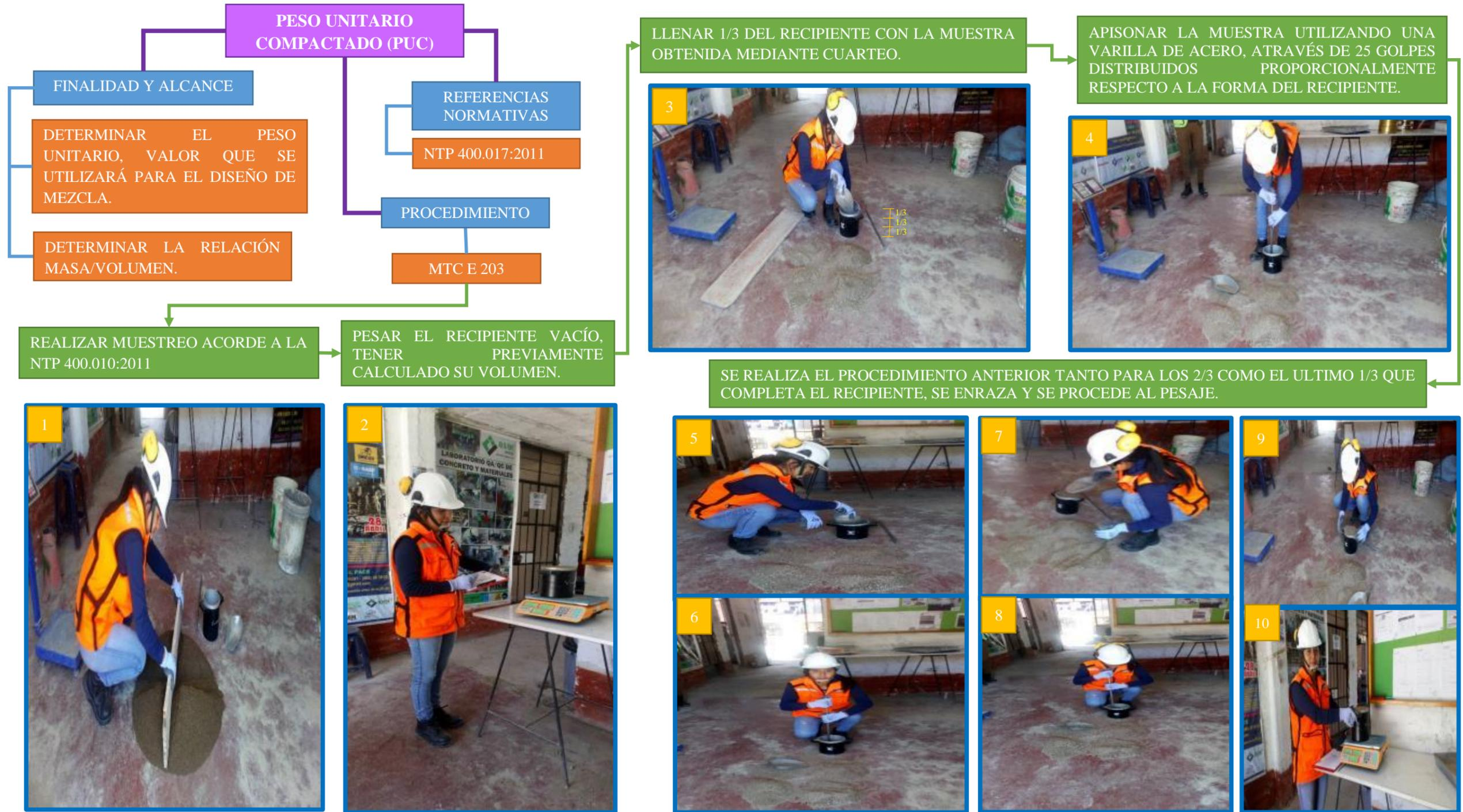
$$P.U.C = \frac{(\text{Peso del Agregado Fino Compactado} + \text{Peso del Recipiente}) - \text{Peso del Recipiente}}{\text{Volumen del Recipiente}}$$
