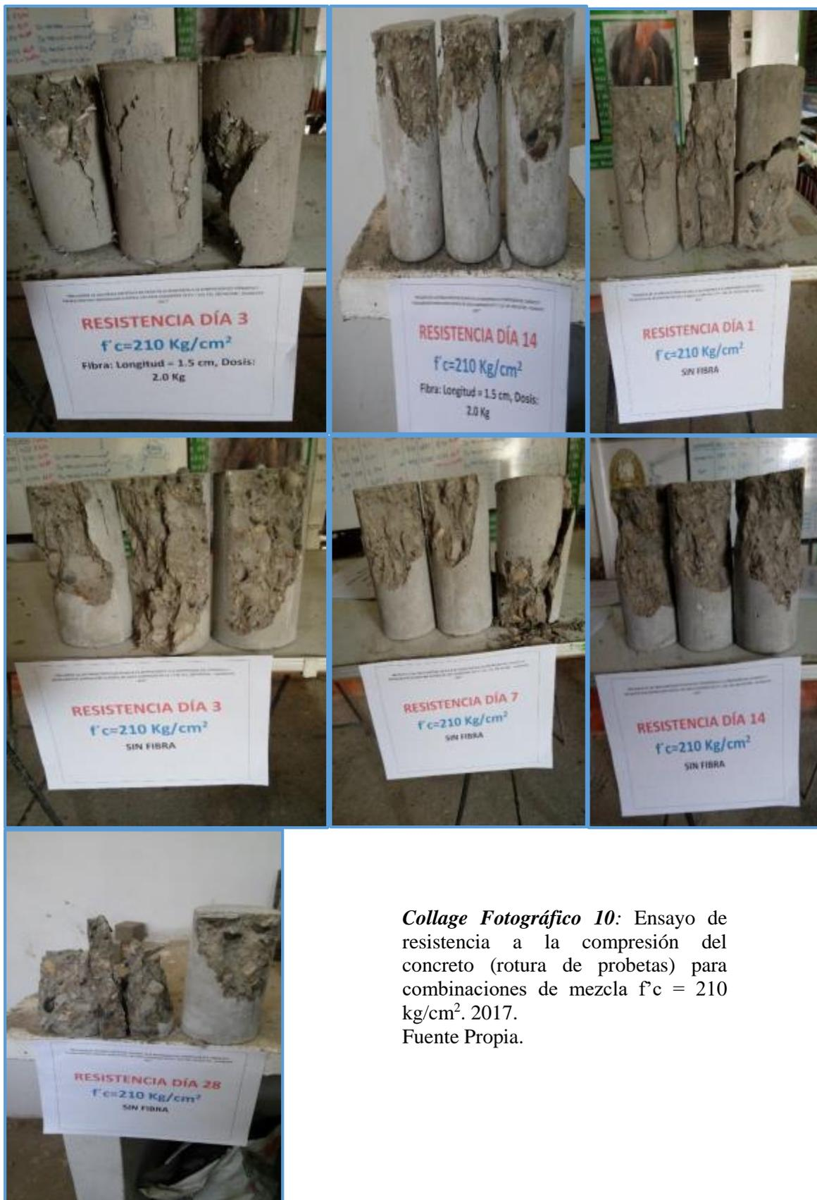
**Collage Fotográfico 10:** Ensayo de resistencia a la compresión del concreto (rotura de probetas) para combinaciones de mezcla  $f'c = 210 \text{ kg/cm}^2$ . 2017. Fuente Propia.
