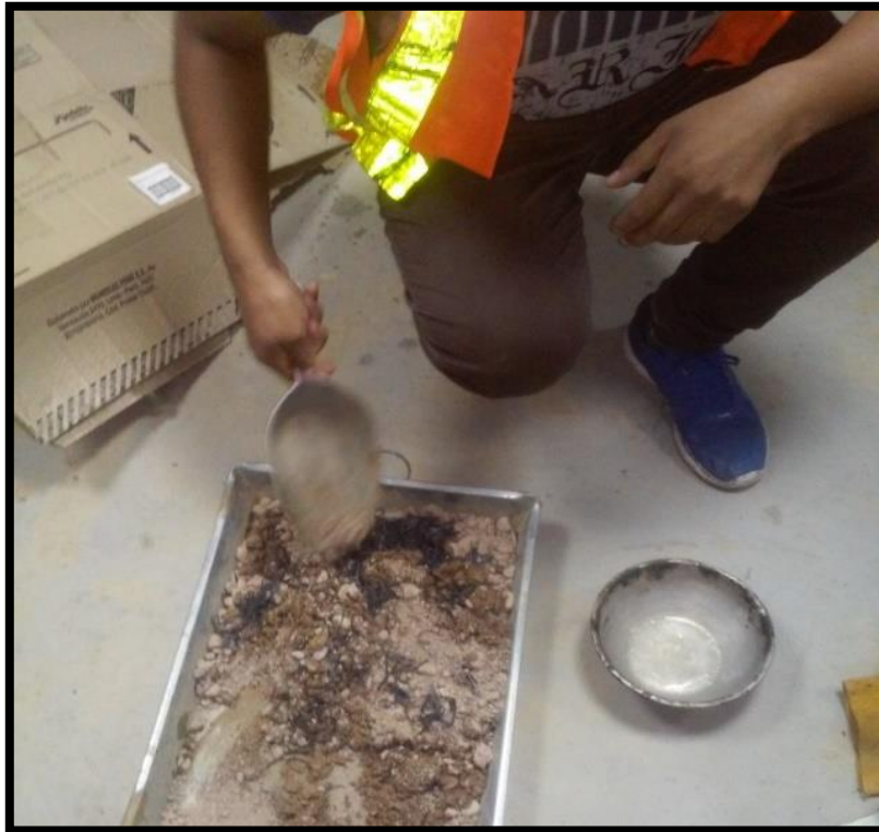
Base granular + agua + fibra de caucho
