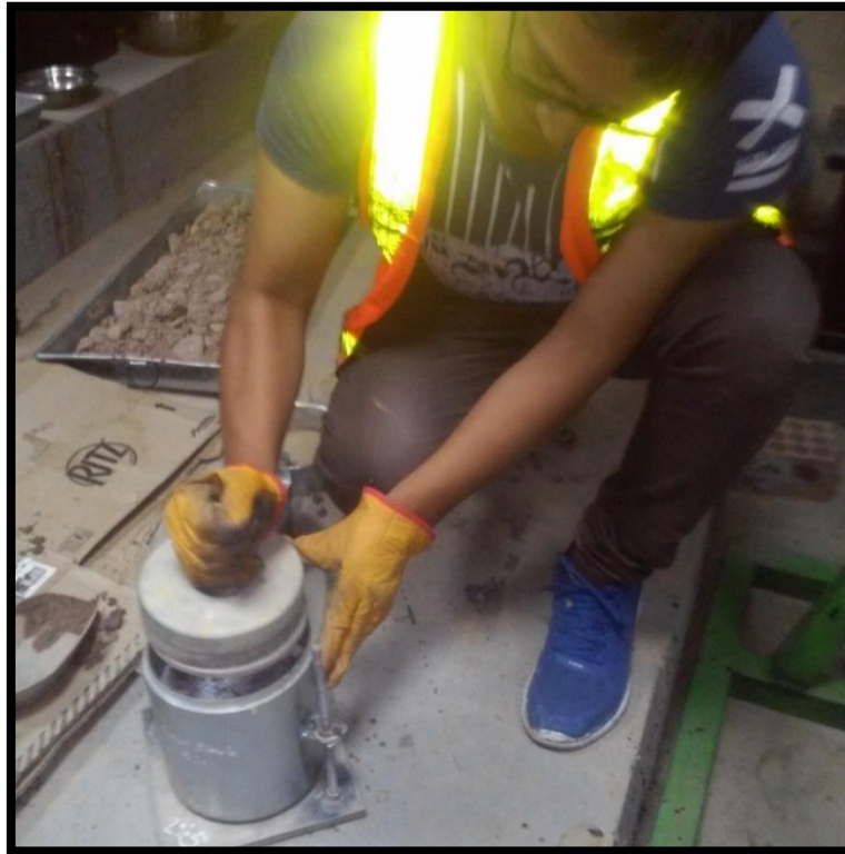
FOTO 24 Colocación de anillos
