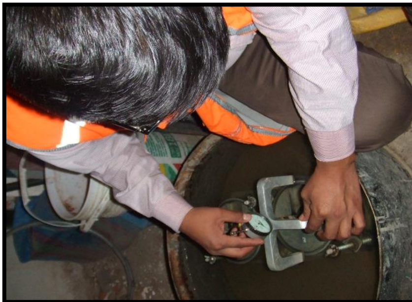
Lectura del dial - Prueba de Expansión
