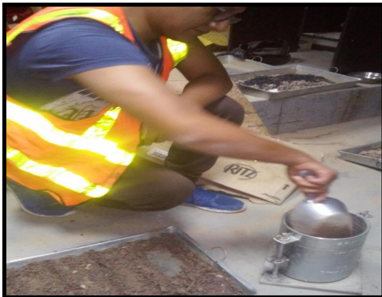
Colocación de la mezcla en el Molde
