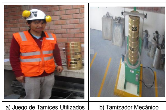
Figura 17. Ensayo de granulometría arena.
