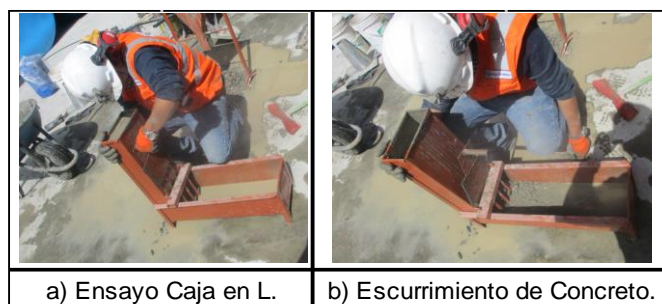
Figura 37. Ensaio en caja en L para las distintas Mezclas de Concreto. Fuente: Elaboración Propia.
