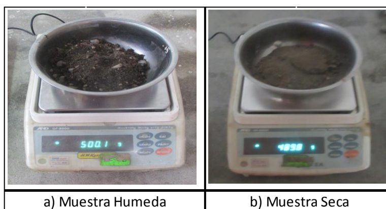
Figura 19. Ensayo de humedad arena.
