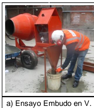
Figura 35. Ensayo de Embudo en V para las Mezclas de Concreto Autocompactante.
