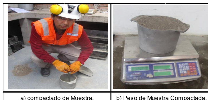
Figura 22. Peso Unitario Compactado de la Arena. Fuente: Elaboración Propia.
