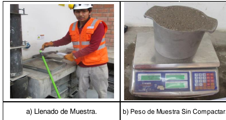
Figura 21. Ensayo Peso Unitario Suelto Arena. Fuente: Elaboración Propia.
