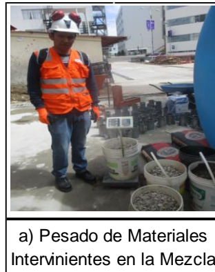
Figura 29. Materiales previamente pesados a utilizar en el mezclado. Fuente: Elaboración Propia.
