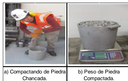
Figura 28. Ensayo Peso Unitario Compactado Piedra Chancada. Fuente: Elaboración Propia.
