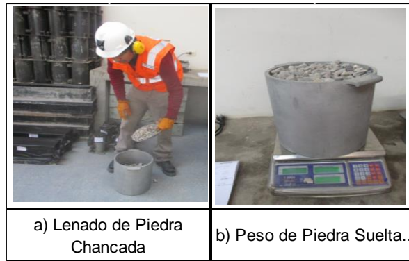
Figura 27. Ensayo Peso Unitario Suelto del Piedra Chancada. Fuente: Elaboración Propia.
