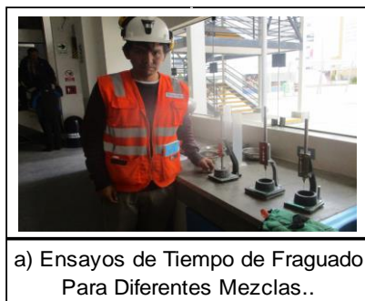
Figura 31. Ensayo Tiempo de Fraguado para las Distintas Mezclas de Concreto. Fuente: Elaboración Propia.
