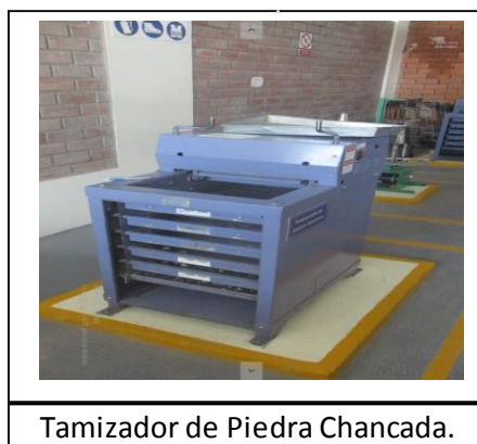
Figura 23. Ensayo de Granulometría Piedra Chancada. Fuente: Elaboración Propia.
