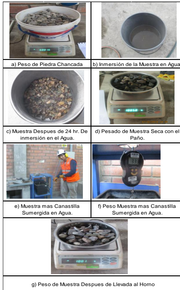
Figura 26: Ensayo del Peso Especifico y Absorción de la Piedra Haciendo uso de la Canastilla.
