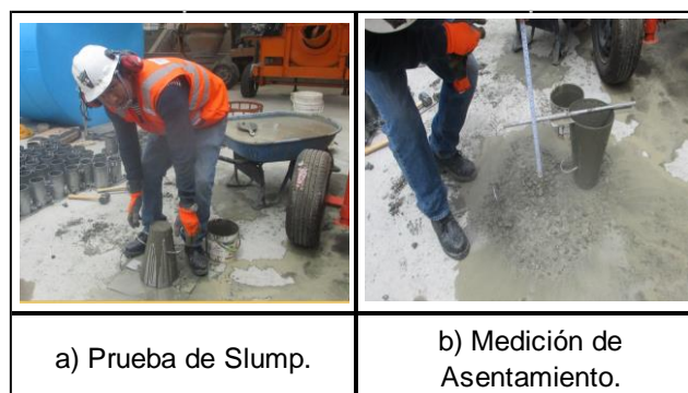
Figura 30. Ensayo de Slump a la Mezcla del Concreto. Fuente: Elaboración Propia.
