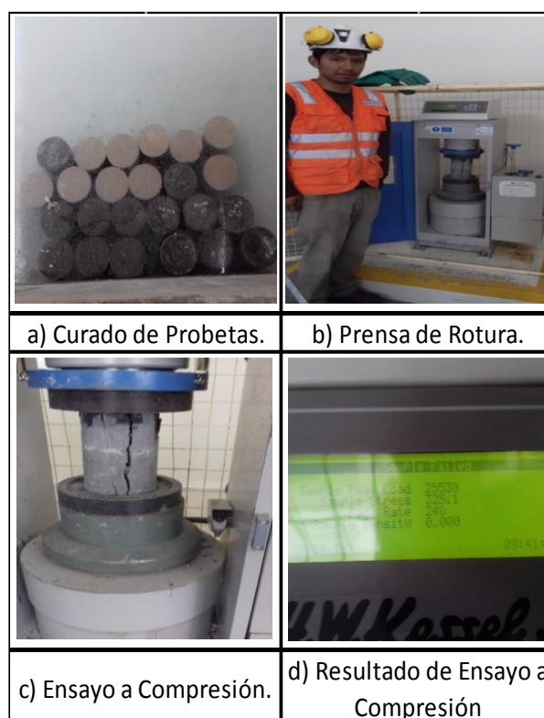
Figura 38. Resistencia a la compresión de testigos de concreto.
