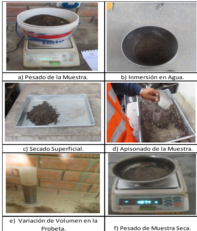
Figura 20: Ensayo del peso específico y absorción de la arena haciendo uso de una probeta graduada.
