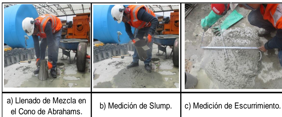
Figura 33. Ensayo de Escurrimiento del Concreto Autocompactante.
