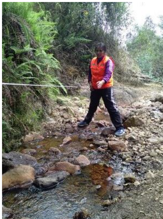
FOTOGRAFIA N°06: Mediciones respectivas para la toma de datos de caudal – ACP Ilish Pichacoto.
