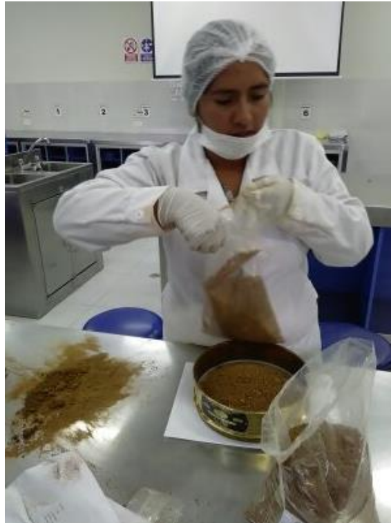
FOTOGRAFIA N°09: Tamizado de las muestras de suelo.
