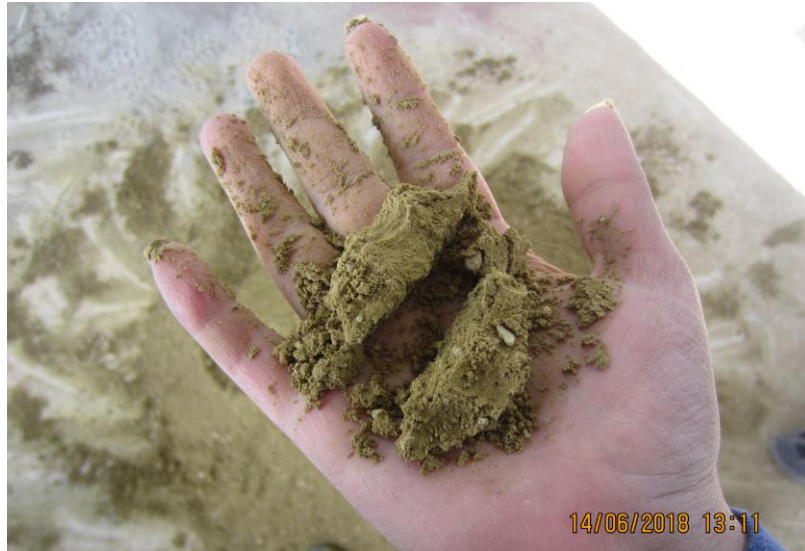
Figura 97 Prueba de puño para hidratación correcta Fuente: Elaboración Propia
