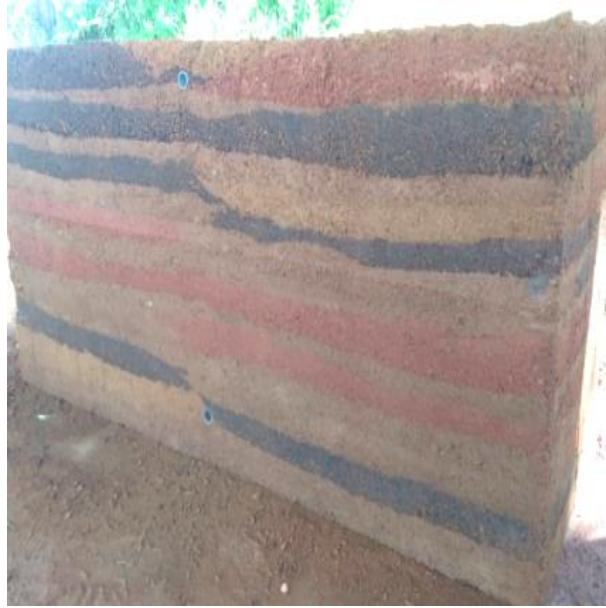
Figura 87 Prueba de pigmentación color negro
