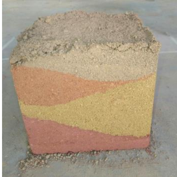
Figura 86 Prueba de pigmentación color rojo y amarillo
