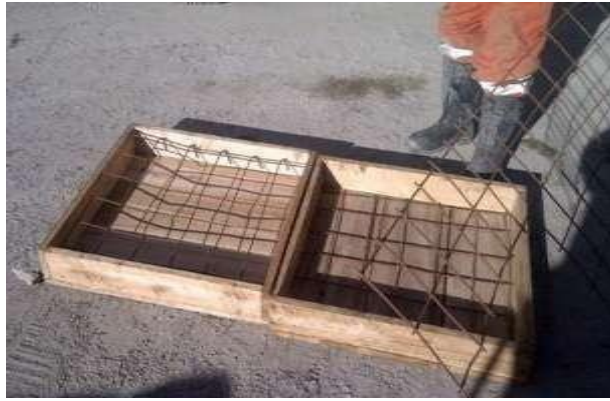
Figura 33. Proceso de preparación de Paneles para la obtención de la Muestra de Sostenimiento Estructural (Shotcrete – Malla – Shotcrete) Fuente: fotografía tomada por el autor
