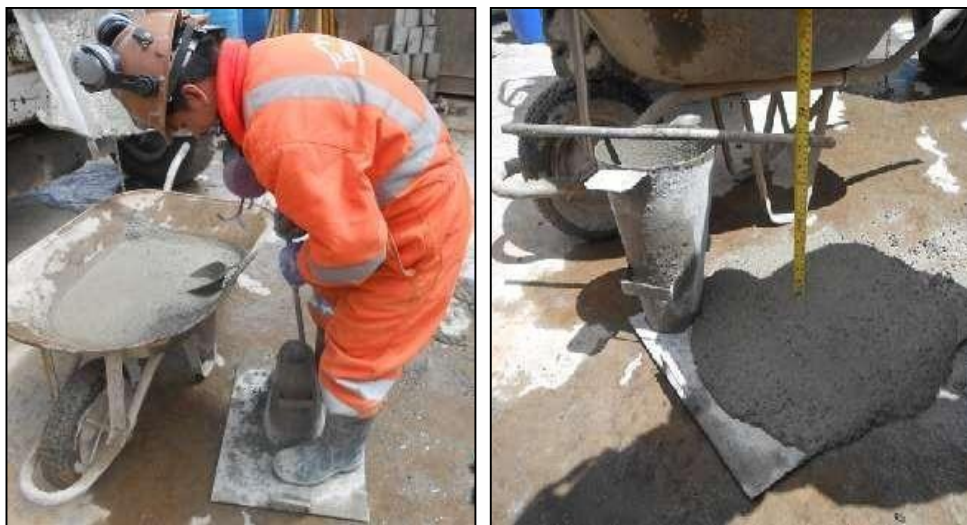
Figuras 35 y 36. Proceso y Medición de Slump de shotcrete en la Planta de Concreto, antes que sea transportado a interior mina Fuente: fotografías tomadas por el autor
