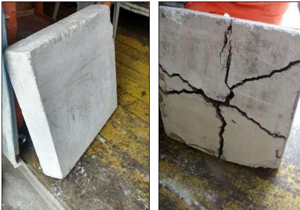
Figuras 48 y 49. Panel cuadrado antes y después de ser ensayado
