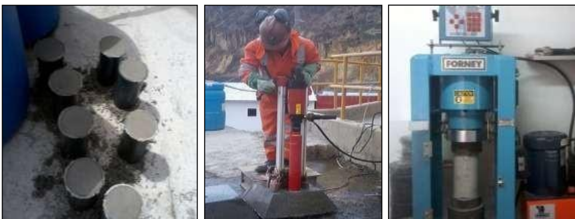
Figuras 40, 41 y 42. Obtención, preparación y ensayo de resistencia a la compresión a los 28 días Fuente: fotografías tomadas por el autor
