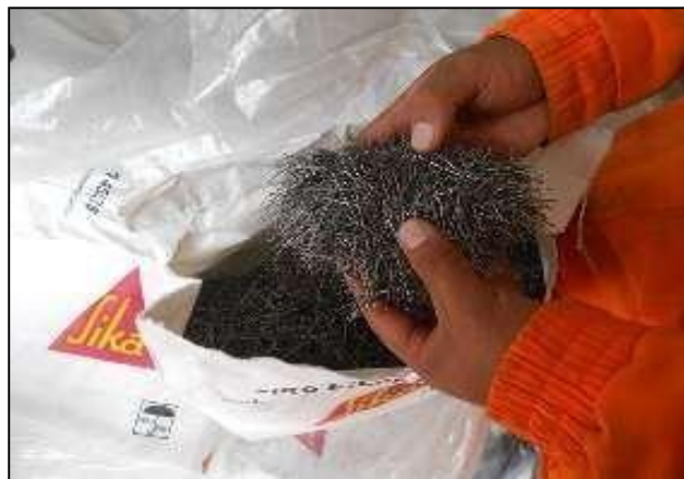
Figura 16. Fibras de acero Sika LHO 45/35 NB para refuerzo del shotcrete Fuente: fotografía tomada por el autor
