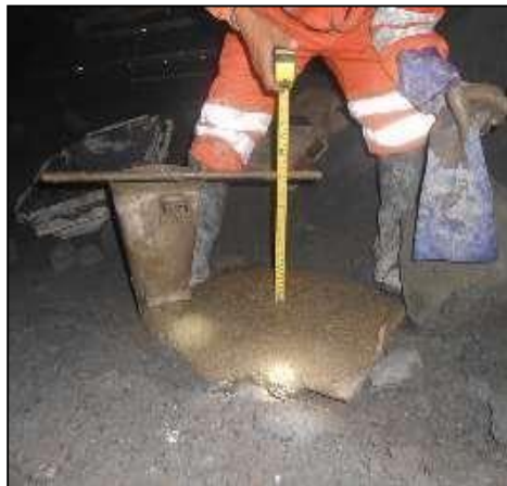
Figura 29. Medición de Slump en Interior Mina Fuente: fotografía tomada por el autor
