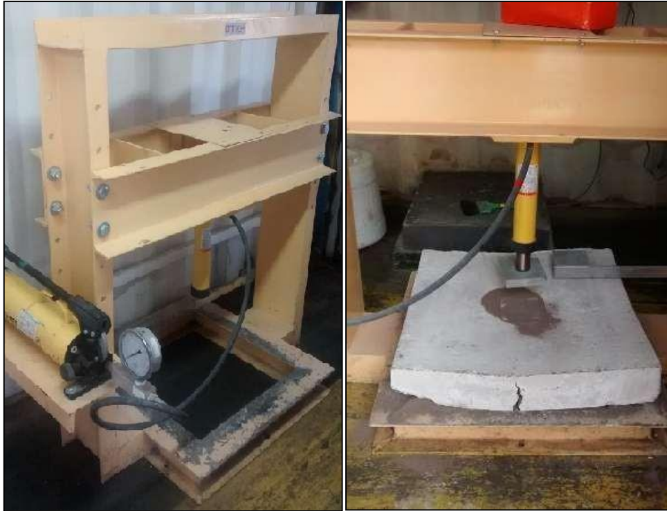
Figuras 46 y 47. Equipo para ensayos de capacidad de absorción de energía (antes y después de realizar el ensayo)
