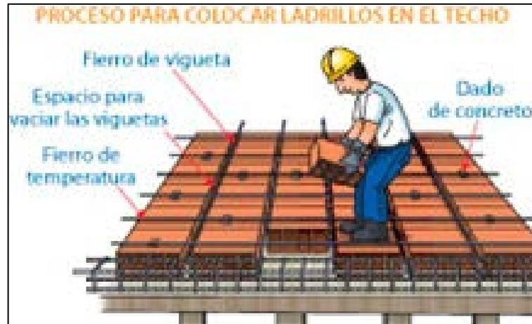
Gráfico 22. Proceso de colocación de ladrillo de techo.
