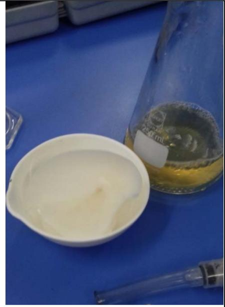
Filtración del agua para medir los SST.
