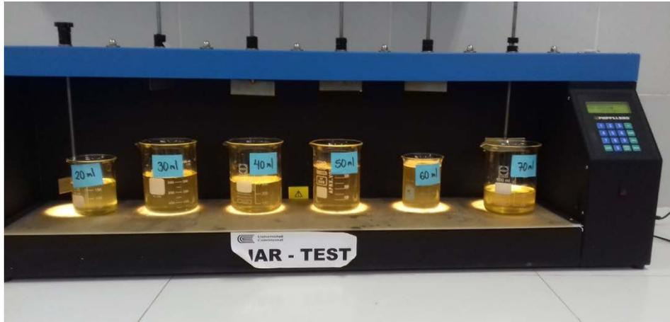
Se observa las muestras sometidas a diferentes dosis de coagulante natural después de la sedimentación.
