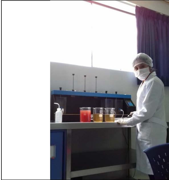
Medición de temperatura, pH, Turbidez del agua residual después de ser sometida al tratamiento.
