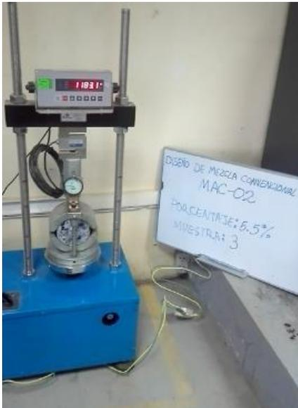
FOTO N° 15. DISEÑO DE MEZCLA CONVENCIONAL MAC-02 AL 5.5%
