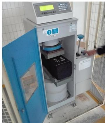
FIGURA 52. Ensayo de resistencia a la flexión en vigas con cargas a los tercios del tramo.
