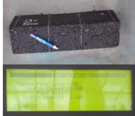
FOTO N° 28. FLEXIÓN DE VIGA CON ADICIÓN DE FIBRA DE 20 mm. Y CARGA MÁXIMA APLICADA.
