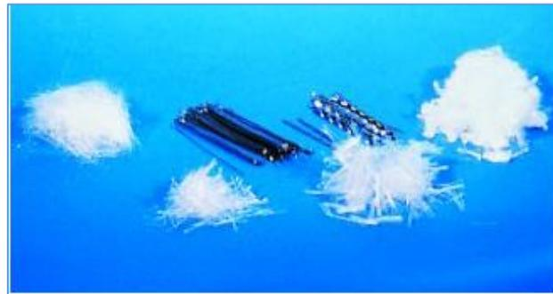
**FIGURA 10.** Fibras utilizadas en la construcción de pavimentos.
