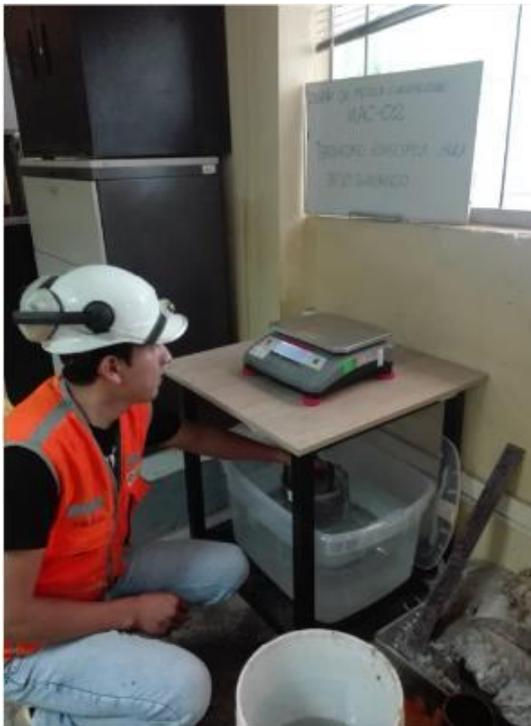
FOTO N° 10. GRAVEDAD ESPECIFICA BULK (PESO SUMERGIDO) PARA ESPECÍMENES MAC 02 - PRE-DISEÑO.
