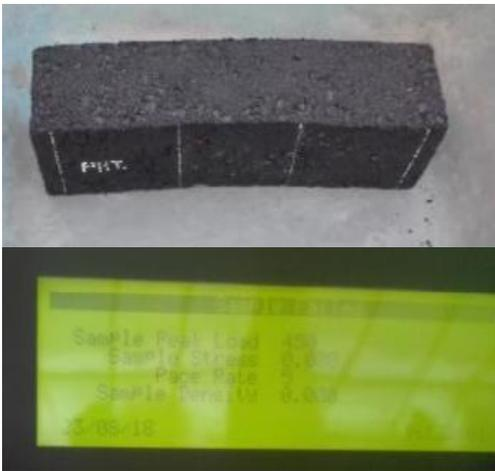
FOTO N° 27. FLEXIÓN DE VIGA PATRÓN Y VALOR DE CARGA MÁXIMA APLICADA.
