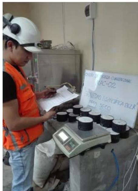
FOTO N° 9. GRAVEDAD ESPECIFICA BULK (PESO SECO) PARA ESPECÍMENES MAC 02 - PREDISEÑO.
