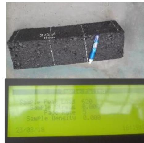
FOTO N° 30. FLEXIÓN DE VIGA CON ADICIÓN DE FIBRA DE 12mm. Y CARGA APLICADA.
