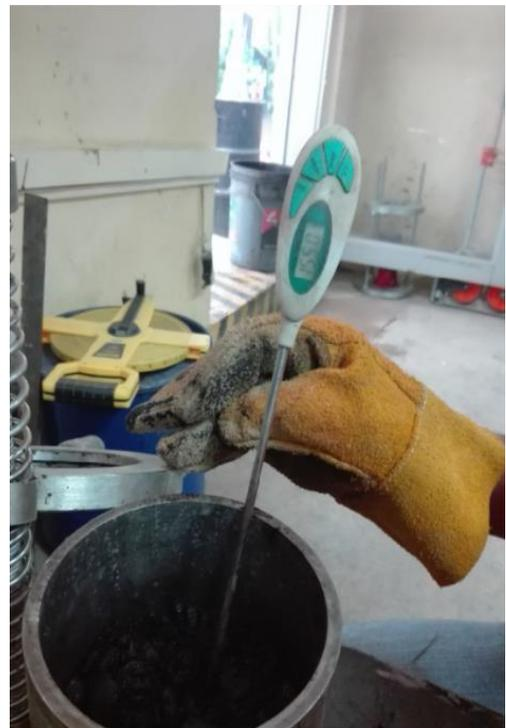
FOTO N° 4. CONTROL DE TEMPERATURA PARA COMPACTADO C.A. AL 4.5% - PREDISEÑO MAC 2.
