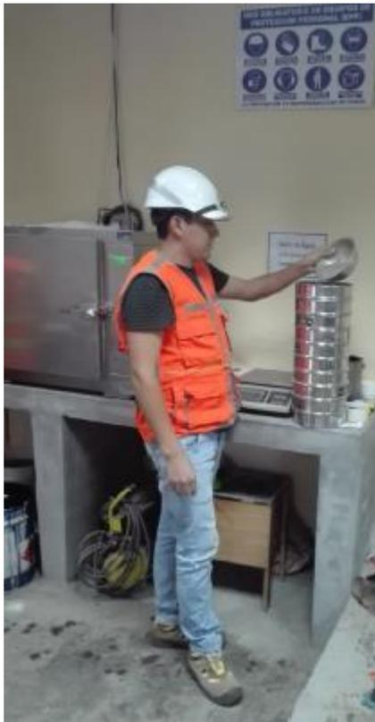
FOTO N° 1. REALIZACIÓN DEL ENSAYO DE ANÁLISIS GRANULOMÉTRICO PARA LA ARENA CHANCADA (PREVIO CUARTEO SEGÚN NORMA MTC E 105).
