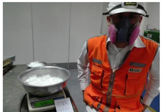
FOTO N° 19. PESAJE DE FIBRAS DE 20mm.
