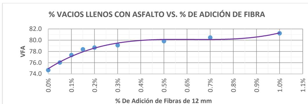
FIGURA 63. Relación del porcentaje de vacíos llenos con asfalto y dosis de fibras de 12 mm.
