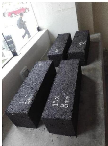
FOTO N° 25. VIGAS DE ASFALTO DESENCOFRADAS.
