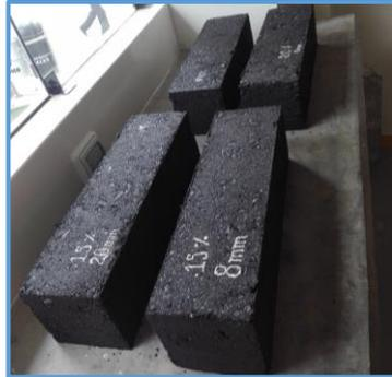
FIGURA 51. Vigas de mezclas asfálticas de 6”x6”x21”.
