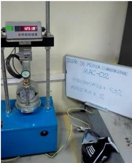
FOTO N° 14. DISEÑO DE MEZCLA CONVENCIONAL MAC-02 AL 4.5%
