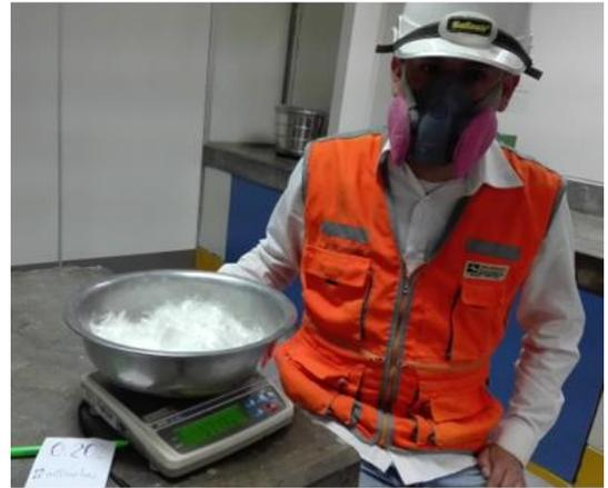
FOTO N° 17. PESAJE DE FIBRAS DE 12mm.
