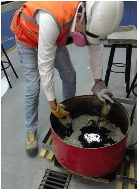
FOTO N° 20. MEZCLADO DE ASFALTO, AGREGADO Y FIBRAS.
