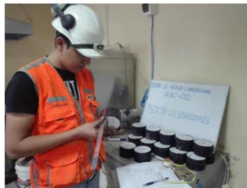
FOTO N° 8. MEDICIÓN DE ESPESORES CON CINTA MÉTRICA.
