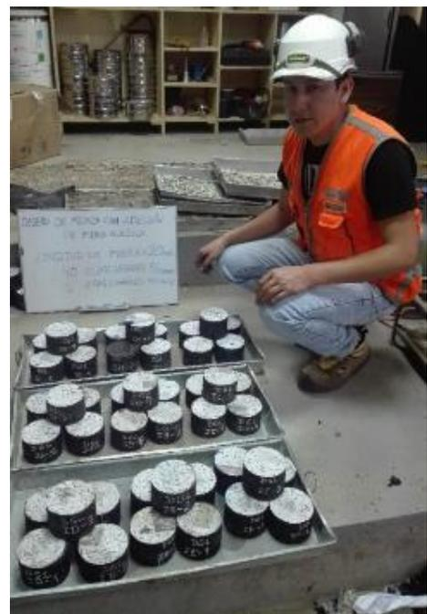
FOTO N° 13. ESPECÍMENES CON ADICIÓN DE FIBRA ACRÍLICA DE 20mm.
