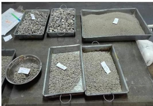
FOTO N° 16. PREPARACIÓN DE AGREGADOS PARA VIGAS.
