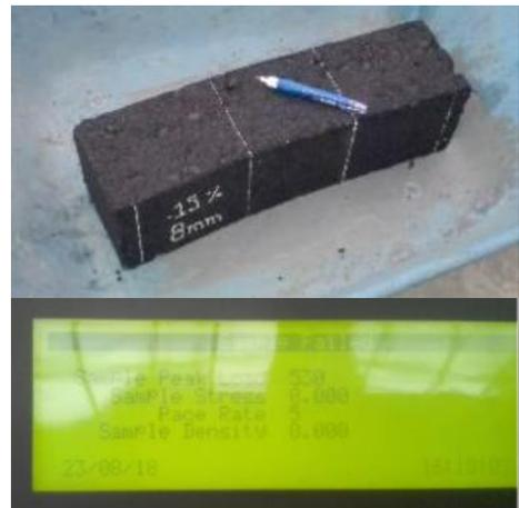
FOTO N° 29. FLEXIÓN DE VIGA CON ADICIÓN DE FIBRA DE 8 mm. Y CARGA MÁXIMA APLICADA.
