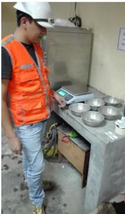
FOTO N° 2. DETERMINACIÓN DE PESOS PARA CADA FRACCIÓN LUEGO DEL CRIBADO- PIEDRA CHANCADA.
