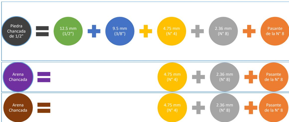
FIGURA 43. Fracciones recomendadas para separar los agregados (ASTM D 6926).
