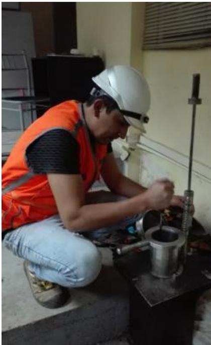
FOTO N° 5. CHUSEADO DE BRIQUETAS ANTES DEL COMPACTADO-PREDISEÑO MAC 2.
