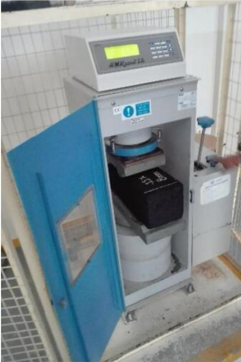
FOTO N° 26. ENSAYO DE RESISTENCIA A FLEXIÓN CON CARGAS EN LOS TERCIOS DE TRAMO CENTRAL.
