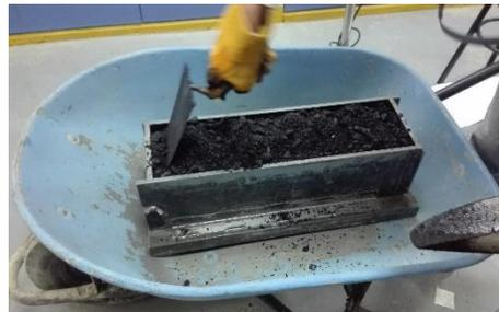
FOTO N° 23. CHUSEADO DE MEZCLA EN VIGA.
