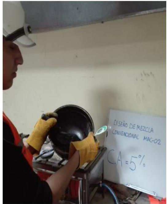
FOTO N° 3. MEZCLADO Y CONTROL DE TEMPERATURA PARA C.A. AL 5.0% - PREDISEÑO MAC 2.
