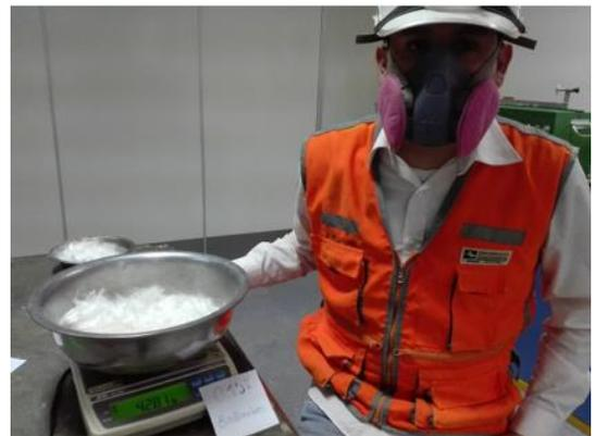
FOTO N° 18. PESAJE DE FIBRAS DE 8mm.
