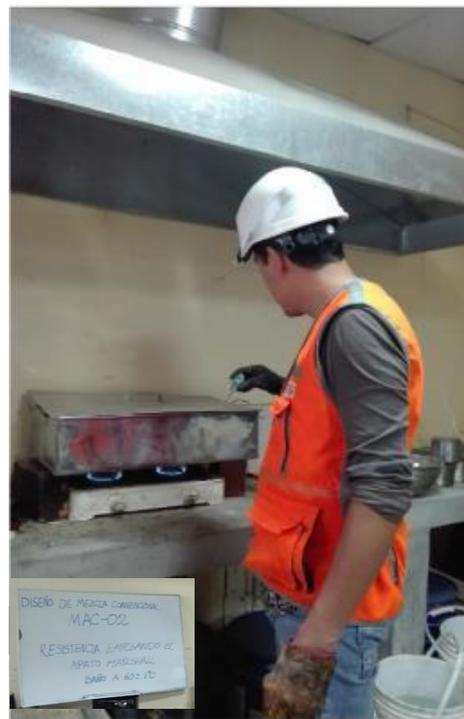
FOTO N° 12. CONTROL DE TEMPERATURA PARA INMERSIÓN DE ESPECÍMENES EN BAÑO CON AGUA A 60°C.
