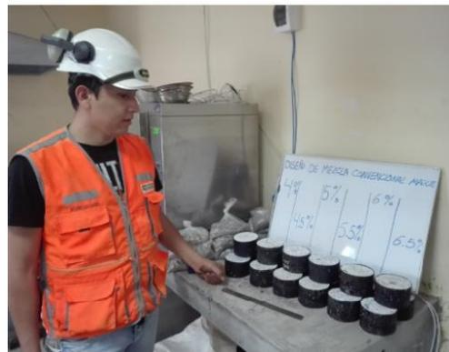
FOTO N° 7. ESPECÍMENES COMPACTADOS - PREDISEÑO MAC 2. (DETERMINACIÓN DE OPTIMO PORCENTAJE DE ASFALTO)
