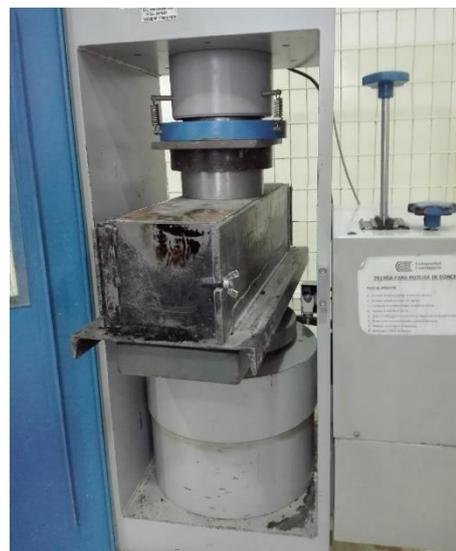
FOTO N° 24. COMPACTADO DE VIGA CON CARGA UNIFORMEMENTE DISTRIBUIDA, MEDIANTE UNA PLACA DE 10mm DE ESPESOR.
