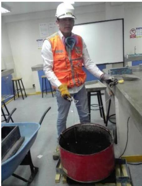
FOTO N° 21. MEDICIÓN DE TEMPERATURA DE LA MEZCLA.
