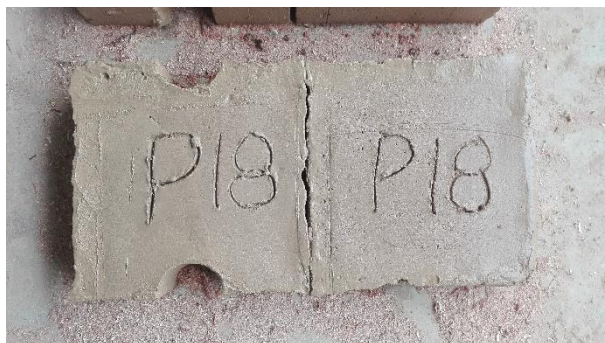
Ilustración 35: Adobe, Prueba 18 FUENTE: Propia
