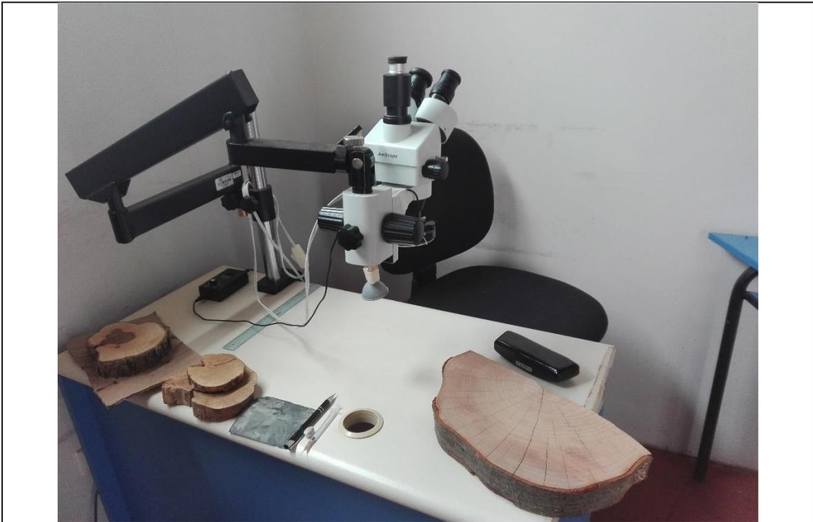
Foto N° 19. Estereomicroscopio donde se observan las muestras ya lijadas
