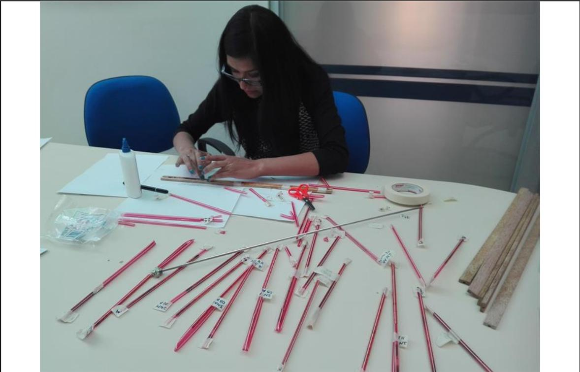
Foto N° 11 Montado de muestras y codificación de muestras.
