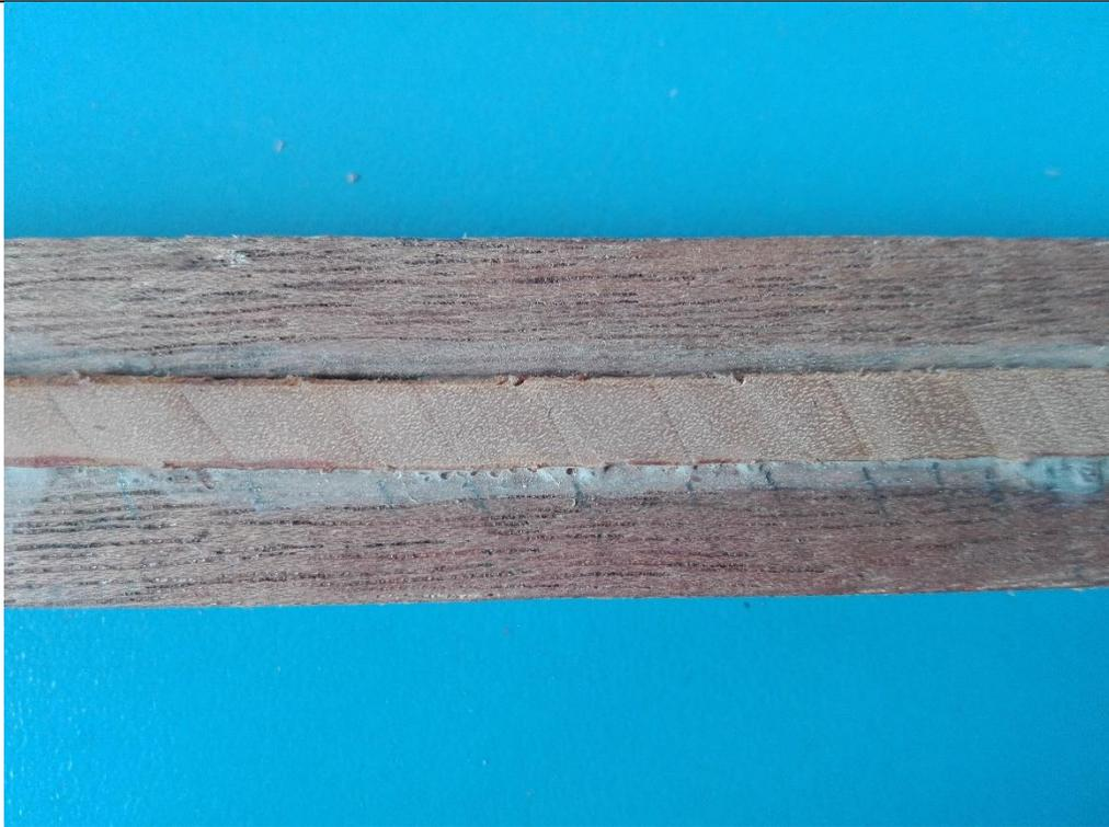
Foto N° 15: Muestra lijada e identificación de los anillos anuales.
