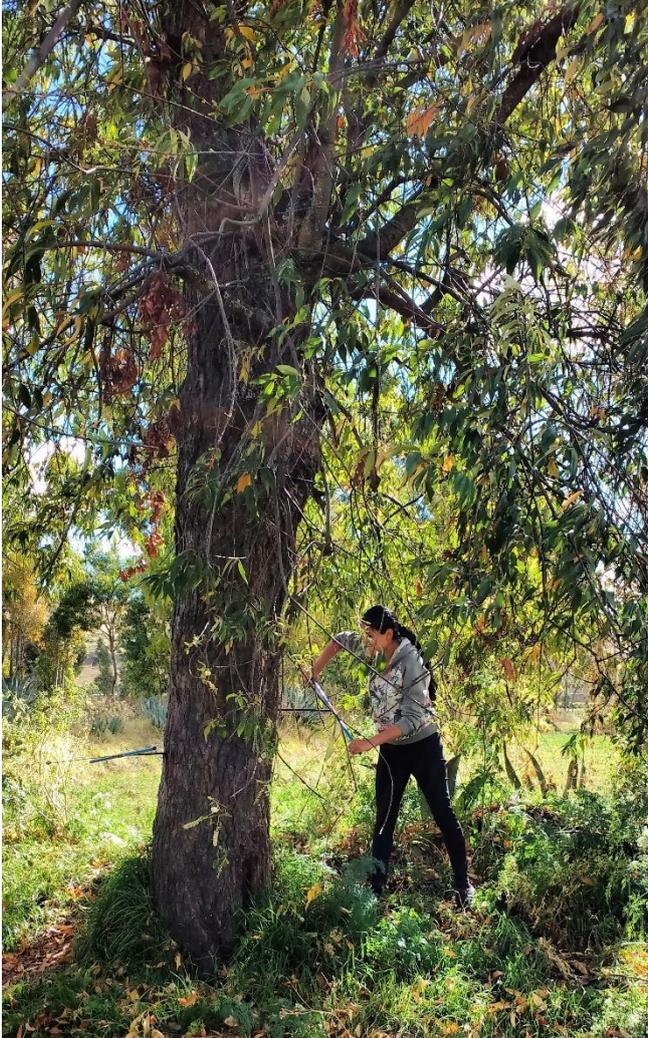
Foto N° 1 : Extracción de muestras con la ayuda del Barreno.
