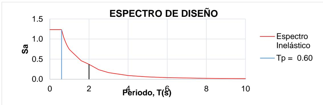
Figura 152: Espectro de Aceleraciones en el sentido X y Y (R=8)
