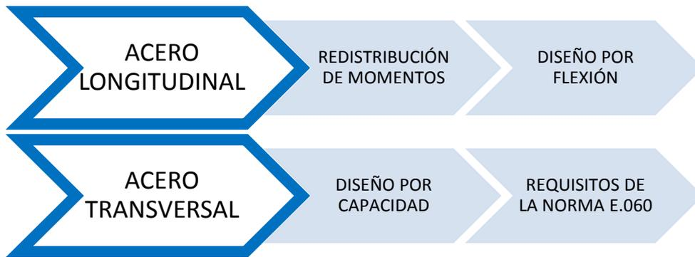
Figura 164: Proceso del diseño de vigas
