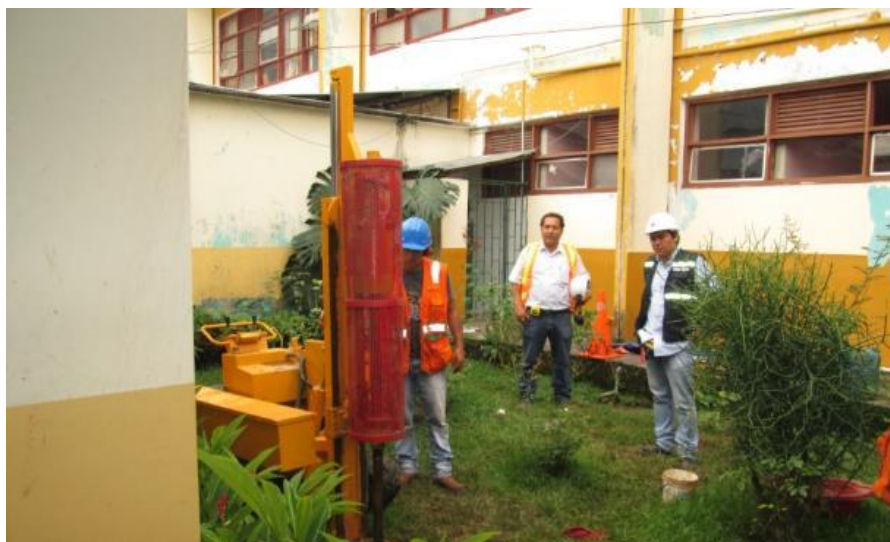
Imagen 47 : Ensayos tipo SPT a 5.55 m.
