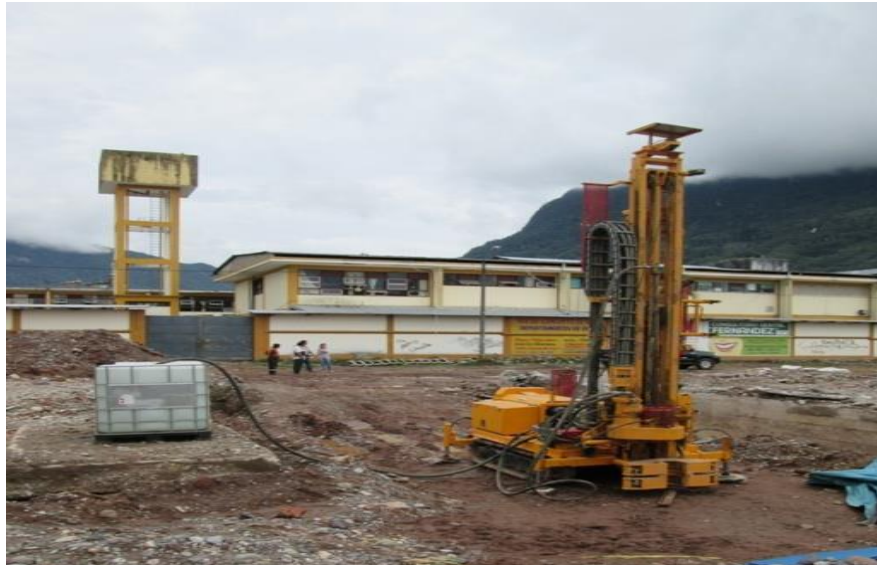
Imagen 47 : Ensayos tipo SPT a 5.55 m.
