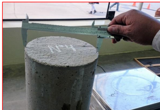
Figura 71: Medida del diámetro de las probetas (diámetro superior y diámetro inferior)
