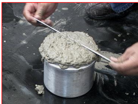
Figura 56: Enrasado de la superficie del concreto
