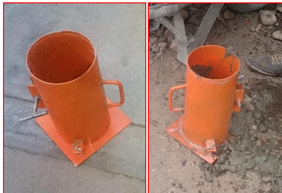
Figura 57: Molde cilíndricos de 6 x 12 pulgadas (15 x 30cm)
