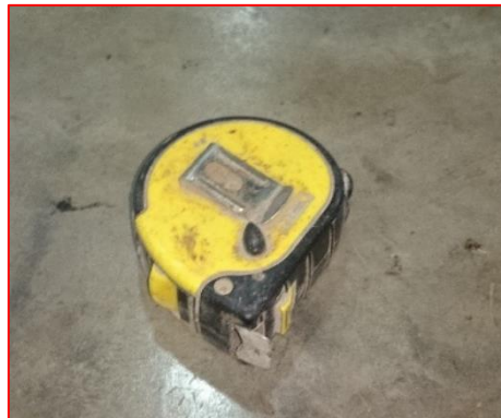
Figura 67: wincha (para medir la longitud de las probetas)
