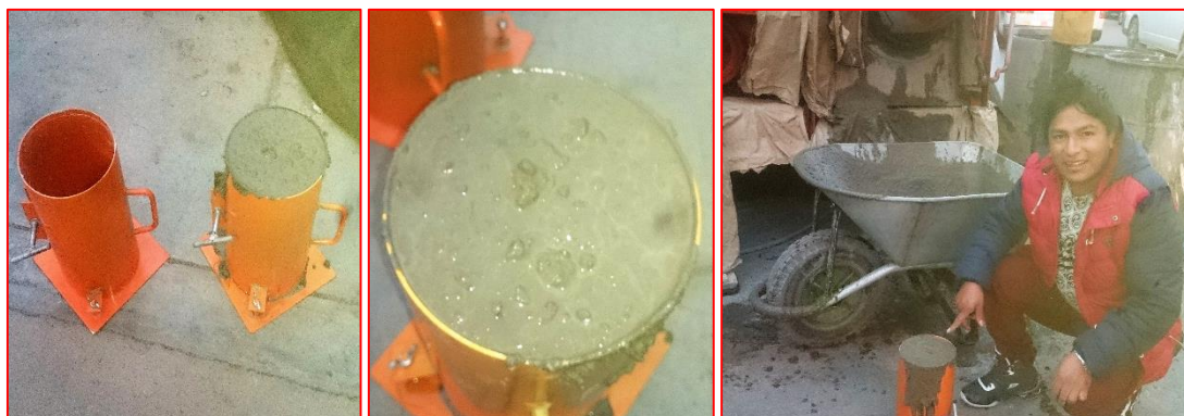
Figura 61: Llenado y compactado en tres capas
