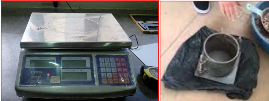
Figura 54: Pesado del molde metálico
