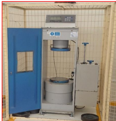
Figura 64: Prensa para ensayo de resistencia a la compresión
