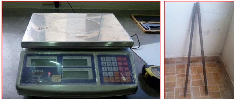
Figura 52: Balanza electrónica y varilla de Ø 5/8" (16 mm) x 24" (600mm)
