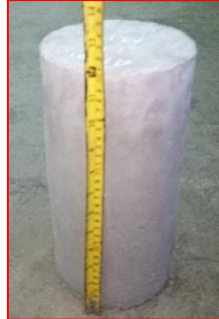
Figura 72: Medida de la longitud de probetas (en tres puntos distintos alrededor del diámetro)
