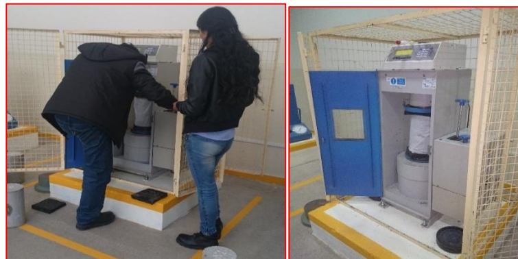
Figura 73: Colocado de las probetas en la compresora
