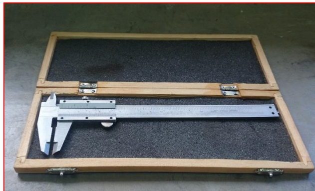
Figura 68: Vernier (para medir los diámetros de las probetas)
