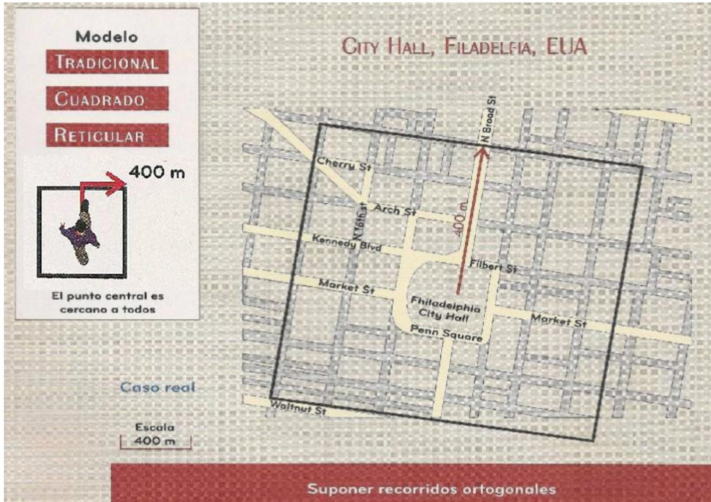
Figura 8. Esquema para el cálculo de zona de impacto a través del método cuadrado reticular
