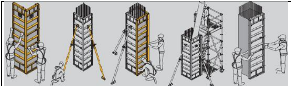
Figura N° 12: Proceso constructivo de encofrado de columnas.
