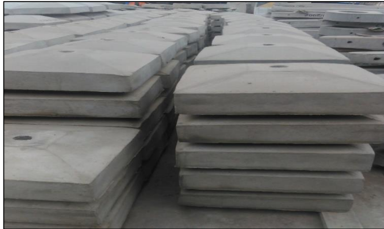
Figura: 17: Bloque de concreto armado de 400 x 400 x 150 mm.
