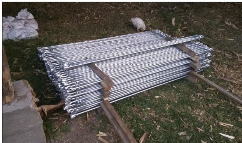
Figura: 16: Varilla de anclaje con ojal-guardacabo de 16mm \Phi diámetro x 1.80 m.
