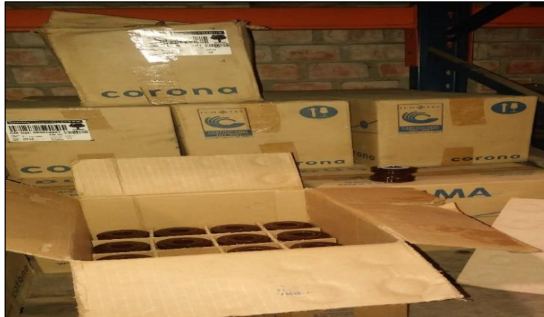
Figura: 15: Almacenamiento Aislador porcelana tipo carrete tipo ANSI 53-1
