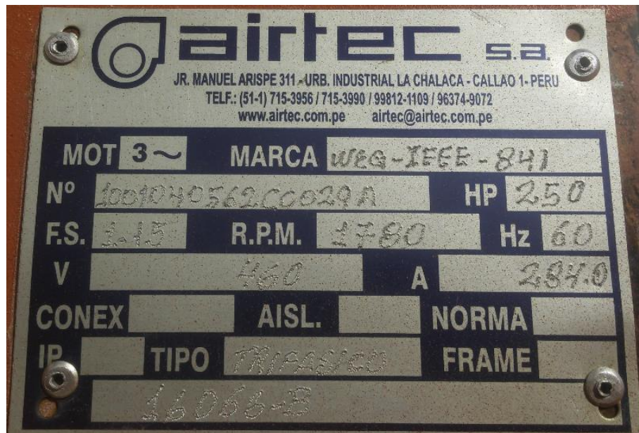
Fotografía 2: Placa de motor del ventilador de 250HP
