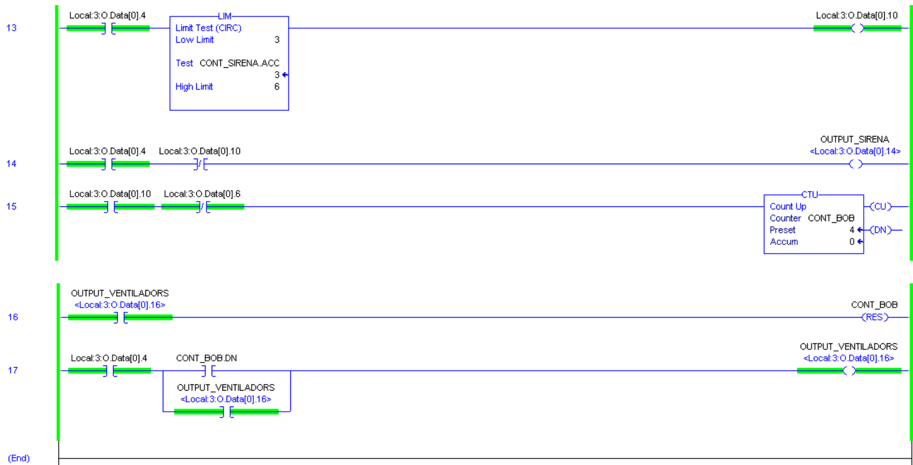
Figura 18: Comprende arranque en fila 9 mediante input (Arranque automático), salida de alarma (Output Sirena) en fila 14 y salida para arranque del ventilador (Output Ventilador) fila 17. Siendo simulado (RSLOGIX 5000)
