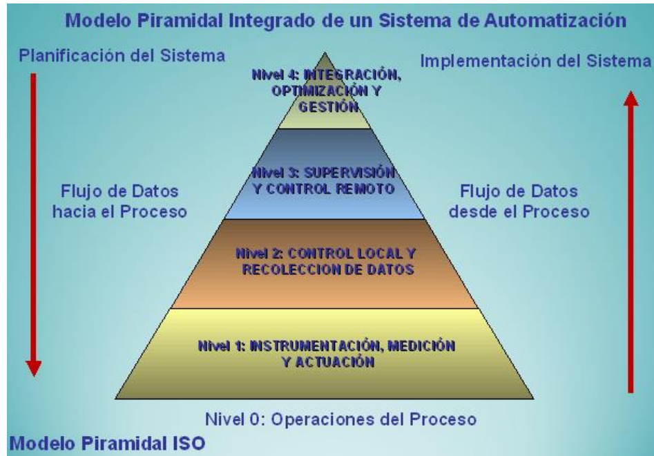
Figura 4: Modelo piramidal integrado de un sistema de automatización
