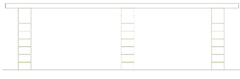
Figura 46: Muro para mesa de cocina
