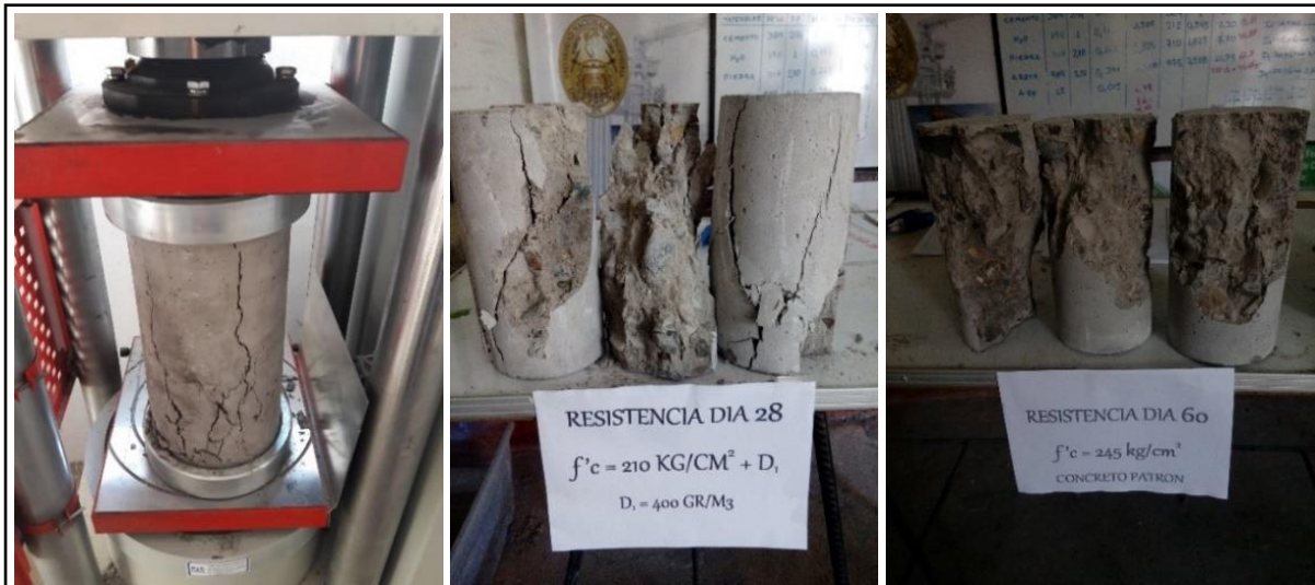
Figura 3. 27 Probetas sometidas a ensayo de compresión
