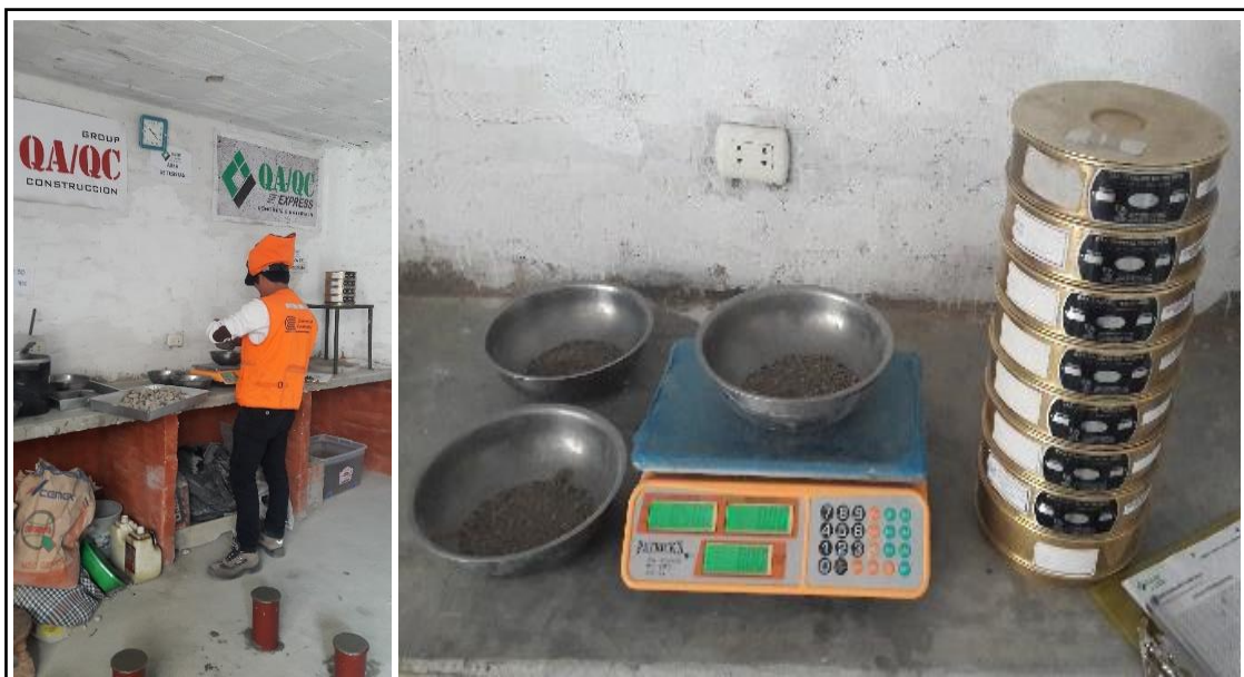
Figura 3. 9 Ensayo de clasificación granulométrica del agregado fino
