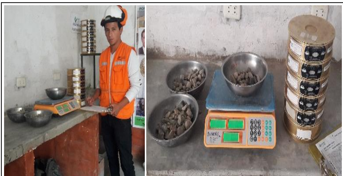
Figura 3. 11 Ensayo de clasificación granulométrica del agregado grueso
