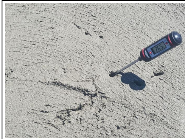
Figura 3. 21 Temperatura de concreto con y sin fibras
