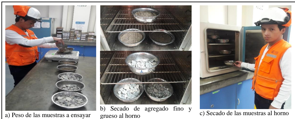
Figura 3. 5 Ensayo de contenido de humedad del agregado grueso y fino
