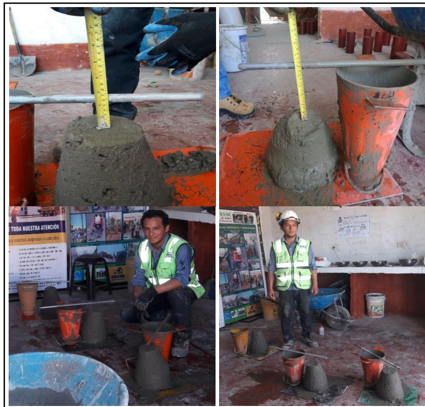
Figura 3. 20 Ensayo de asentamiento de concreto con y sin fibra
