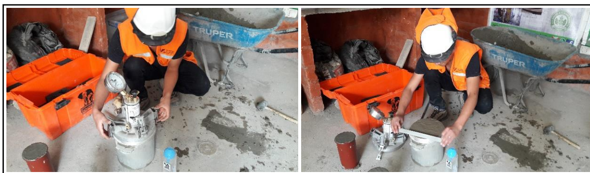
Figura 3. 19 Ensayo de aire atrapado de concreto con y sin fibra.
