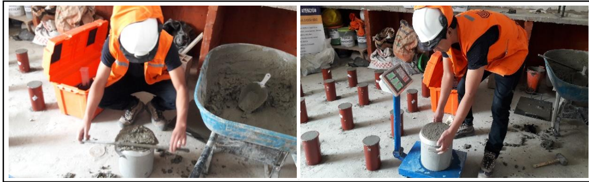
Figura 3. 22 Ensayo de peso unitario de concreto con y sin fibras
