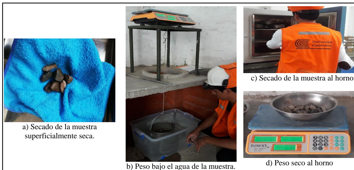
Figura 3. 7 Ensayo de peso específico y absorción de agregado grueso
