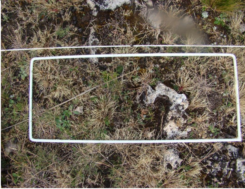
Fotografía 21. ESTABLECIMIENTO DE CUADRO METÁLICO DE 25 x 50 cm PARA LA MEDICIÓN DE BRIÓFITAS
