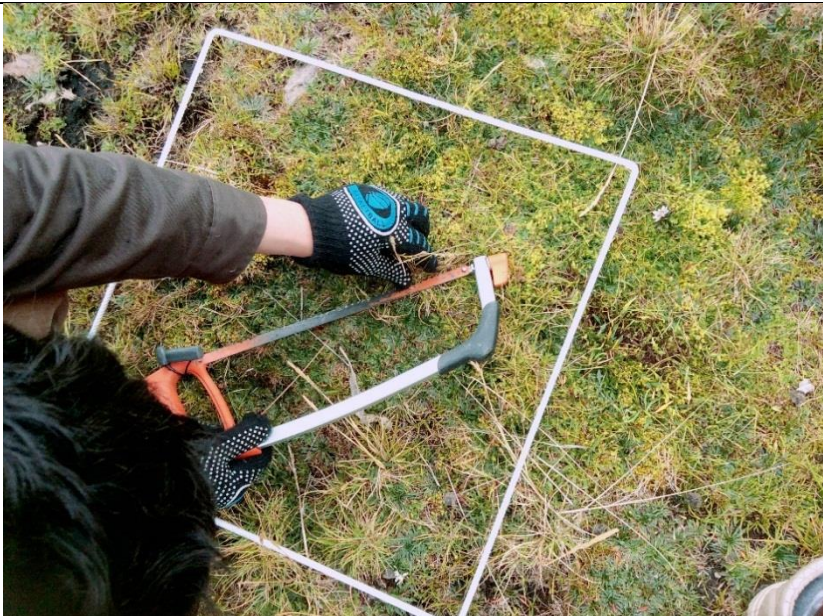
Fotografía 24. CORTADO DE HIERBAS Y CUBIERTA VEGETAL DENTRO DEL CUADRO METÁLICO (SUB-PARCELA)
