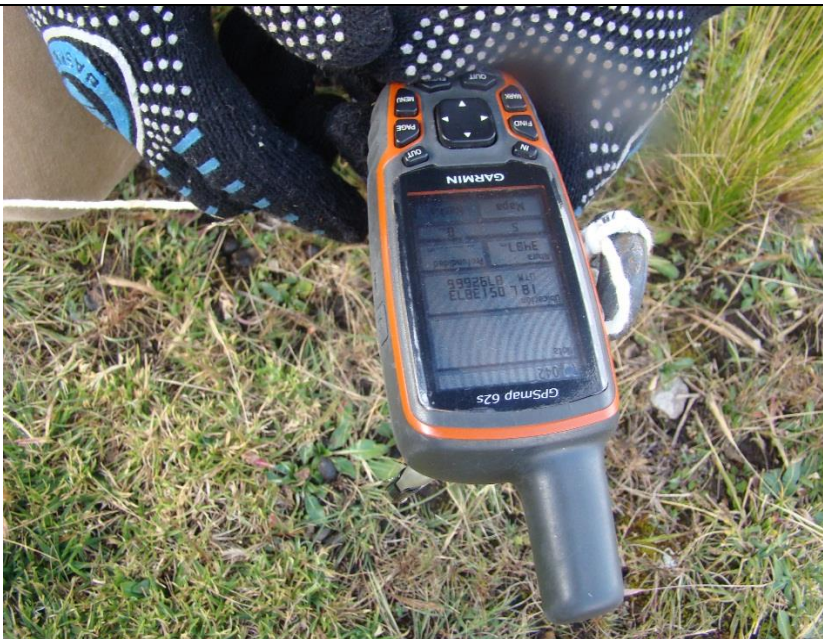
Fotografía 14. UTILIZACIÓN DEL DISPOSITIVO GPS PARA HALLAR LAS COORDENADAS DEL PUNTO CENTRAL DE PARCELAS
