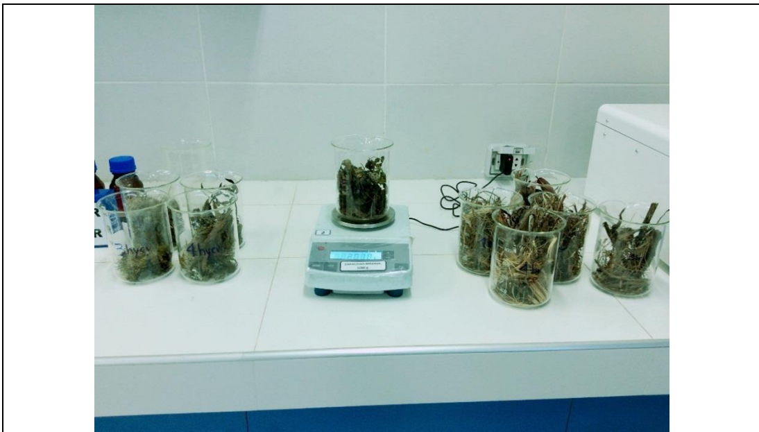
Fotografía 30. PESAJE FINAL DE MUESTRAS LUEGO DEL PROCESO DE SECADO
